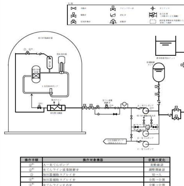
第1.3.4図 加圧器補助スプレイ弁による原子炉冷却材圧力バウンダリの減圧
