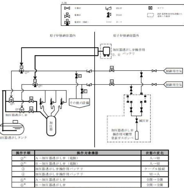
第1.3-12図 加圧器逃がし弁操作用バッテリによる加圧器逃がし弁の機能回復 概要図
