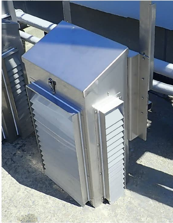
図 4. 2. 4-1 飛来塩分捕集器 (ドライガーゼ法)
