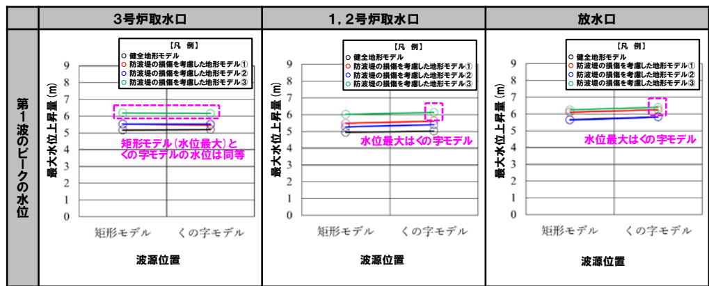
波源位置の変動による第1波のピークの水位への影響
