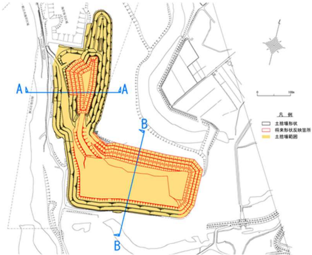
参考図 2-2 (3) 将来計画による土捨場形状
