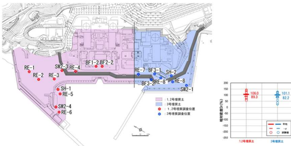
図 2. 1. c. b-2 埋戻土の相対密度調査位置図及び調査結果
