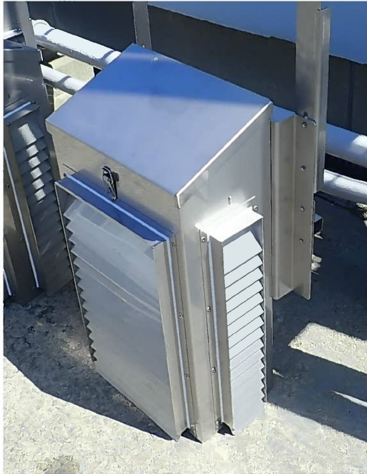
図 4. 2. 4-1 飛来塩分捕集器 (ドライガーゼ法)
