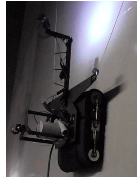
壁面走行ロボット現地写真
