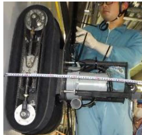
壁面走行ロボット現地写真
