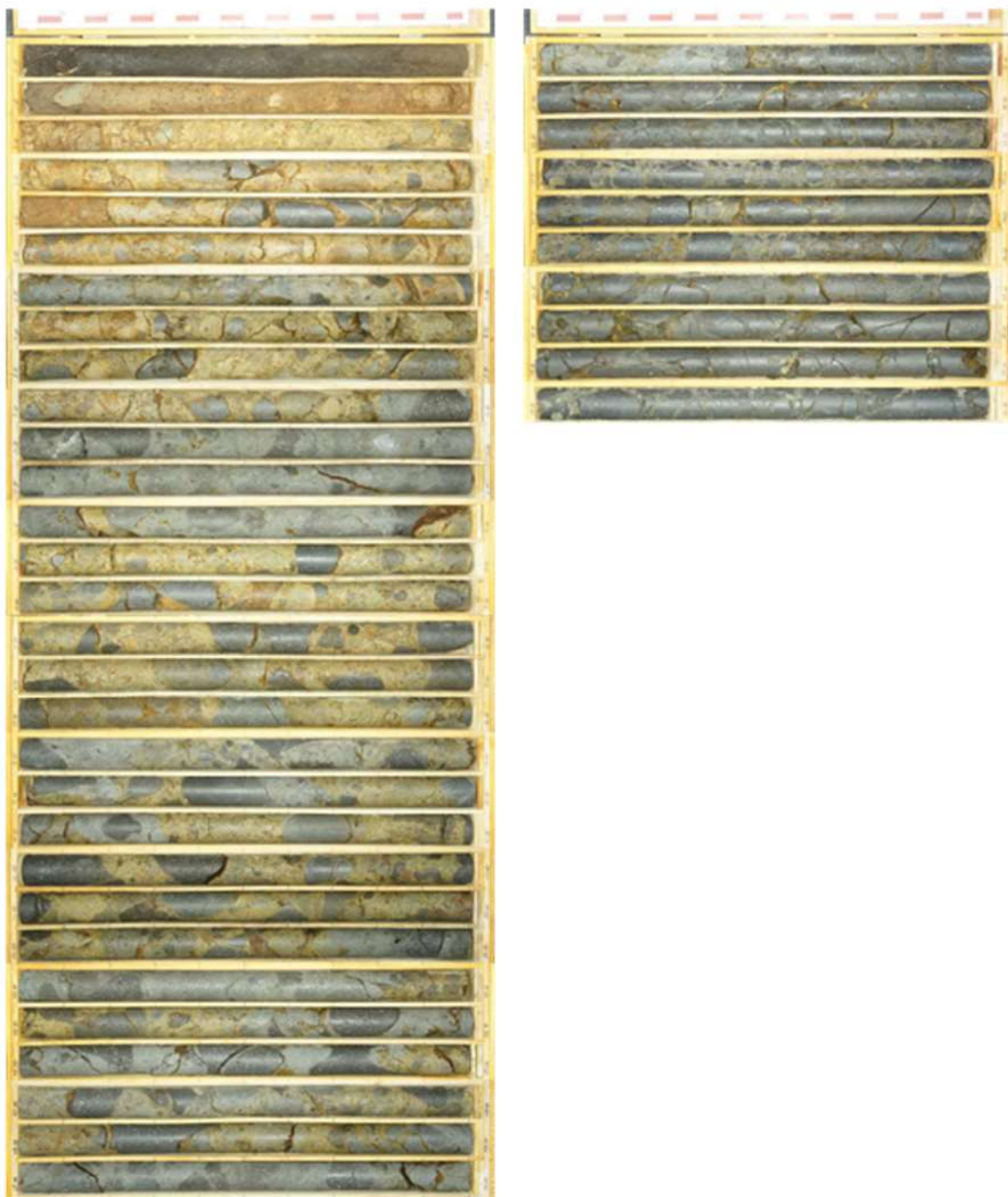
図 2.1.a.c-7 (8) 防潮堤 (掘株側) ボーリングコア写真 鉛直ボーリング (L=40m)
