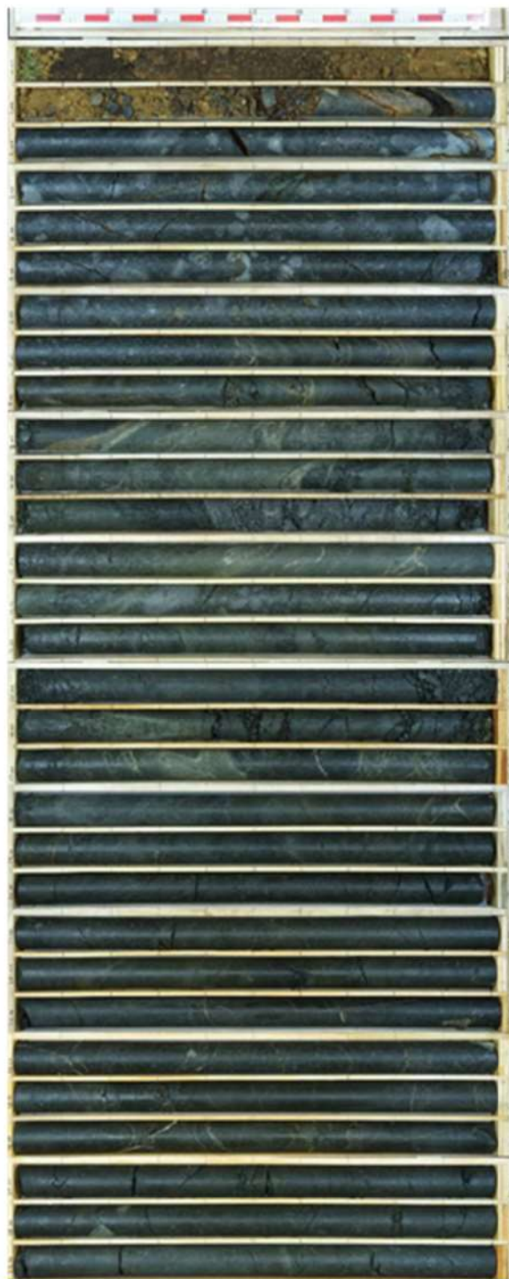
図 2.1.a.c-4 (31) 防潮堤 (茶津側) ボーリングコア写真 R1 敷地-3 ボーリング (L=30m)
