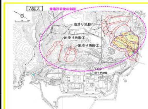
発電所背後の斜面に見られる地滑り地形位置図 (令和5年5月25日審査会合資料(一部修正))
