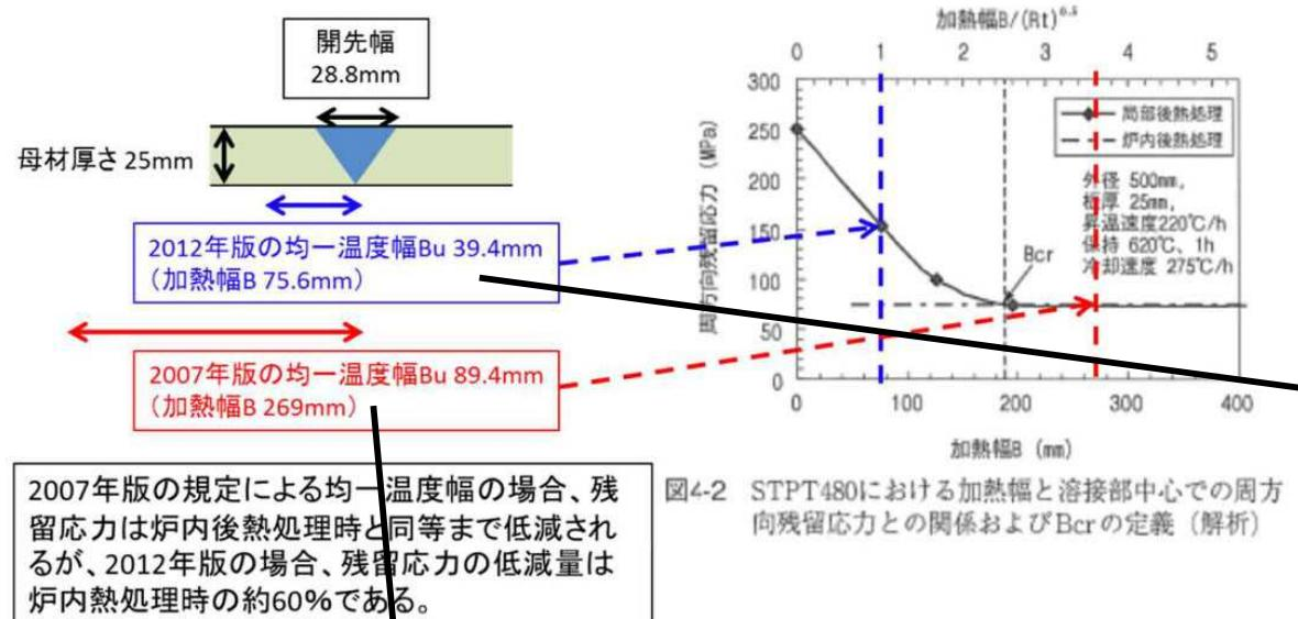
図4 溶接規格 2007年版と2012年版に規定されている加熱幅の比較と
