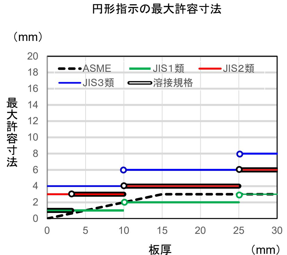
JISでは、きずの寸法だけでなく、試験視野内のきず点数の総和で評価する。試験視野内にきずが1個としてASMEと比較した。
