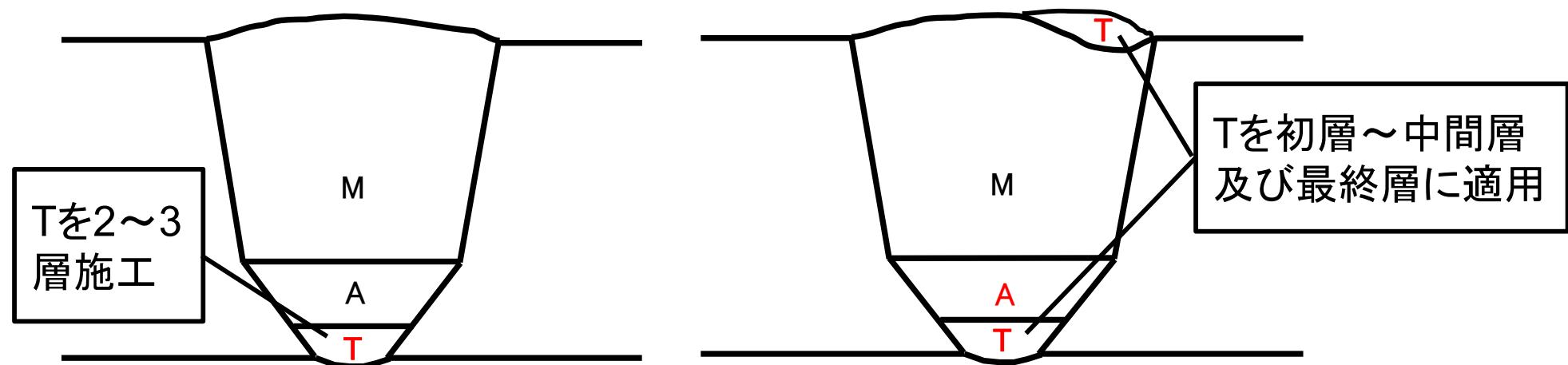
上図の例では、1層目から2~3層目まで施工したティグ溶接を多層溶接と見なしてTとなるが、これを初層溶接 $T_F$ と見なした場合、2012年版溶接規格では左図は $T_F + A + M$ 、右図は $T_F + A + M + T_B$ となる。2020年版では、組合せ施工法はT+A+Mに統一される。
