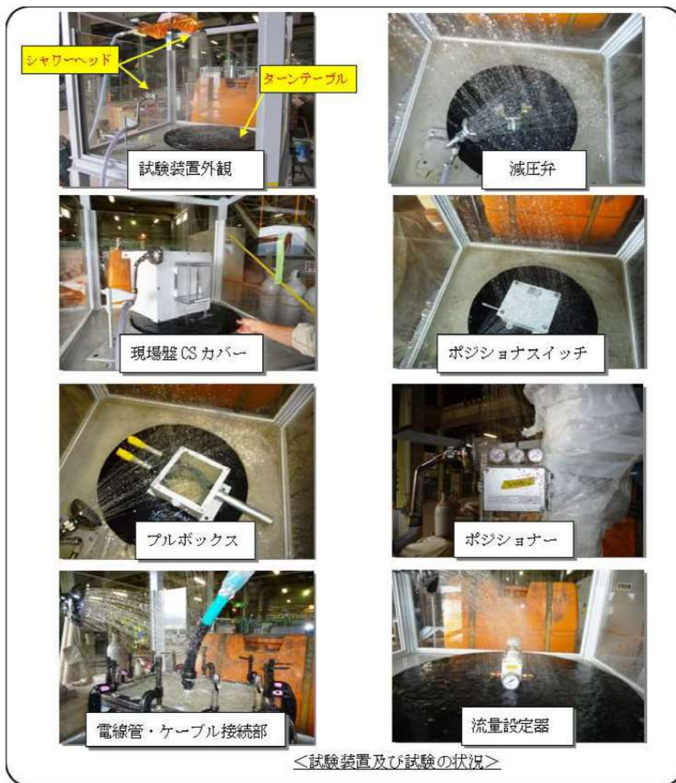
図 3 検証試験の実施状況
