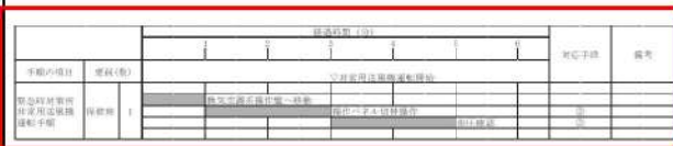
第1.18-3図 緊急時対策所非常用送風機運転手順タイムチャート
