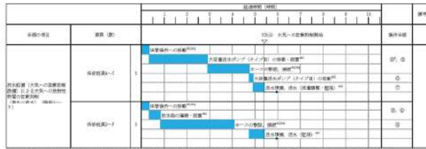
第1.12-2 図 大気への放射性物質の拡散抑制（海水ポンプ室から取水する場合） タイムチャート
