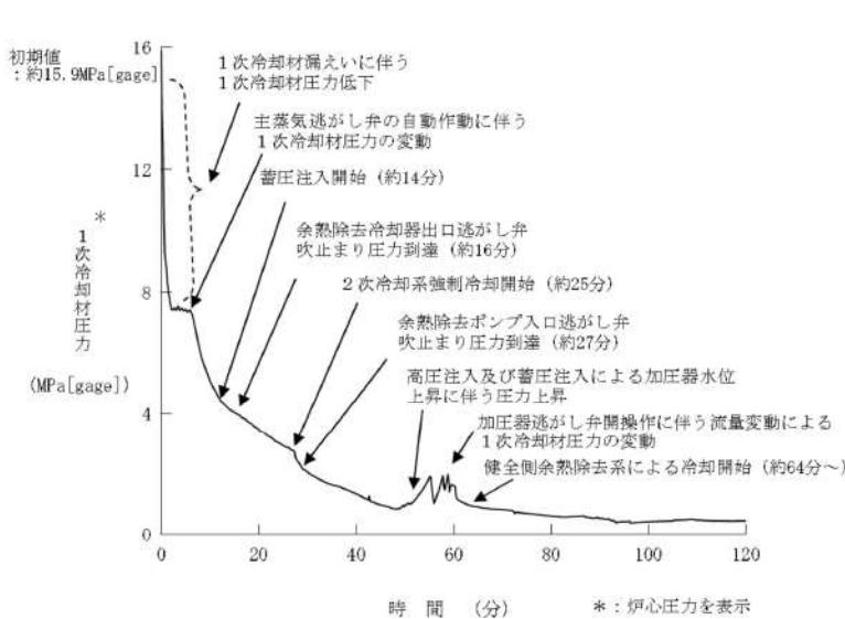
図 7 1次冷却材圧力
