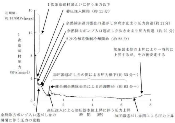
図 7 1次冷却材圧力
