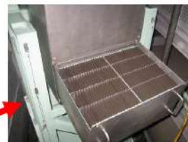
触媒プレート収納部
