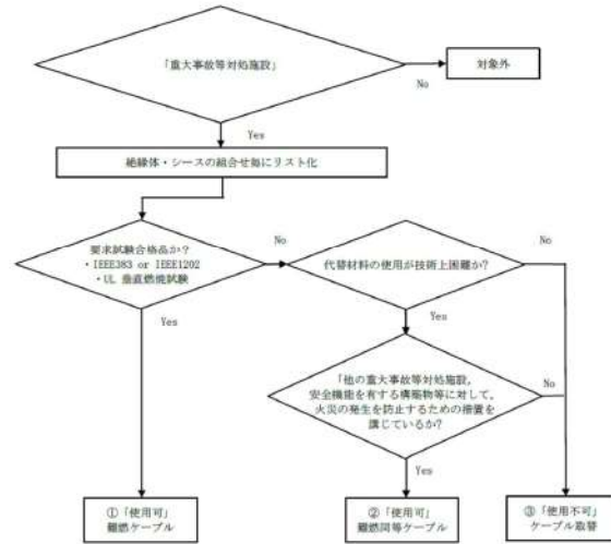
第1図：難燃性ケーブル確認方法
