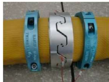
可搬型ホース(150A)接続後
