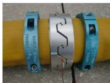
可搬型ホース(150A)接続後
