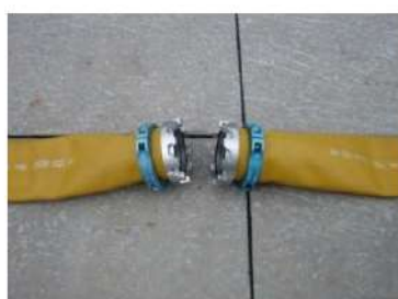
可搬型ホース(150A)接続前
