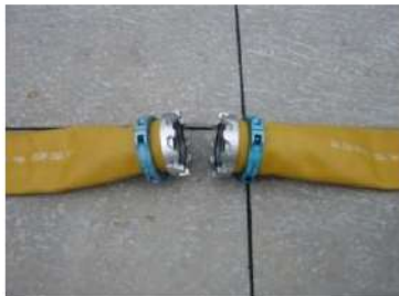
可搬型ホース (150A) 接続前
