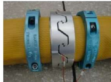
可搬型ホース (150A) 接続後
