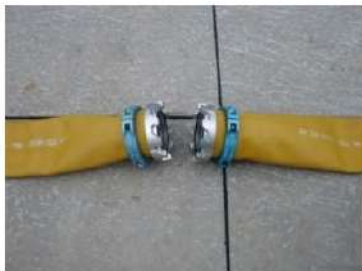
可搬型ホース(150A)接続前
