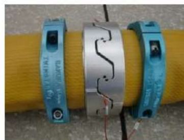
可搬型ホース(150A)接続後
