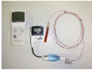
可搬型温度計測装置（格納容器再循環ユニット 入口温度／出口温度） （左：データコレクタ，右：温度ロガー）
