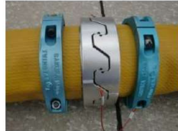
可搬型ホース(150A)接続後
