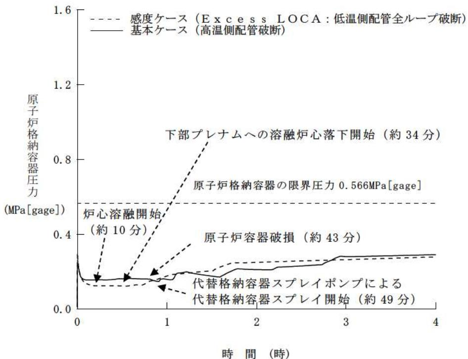
第 7.2.1.1.21 図 原子炉格納容器圧力の推移
