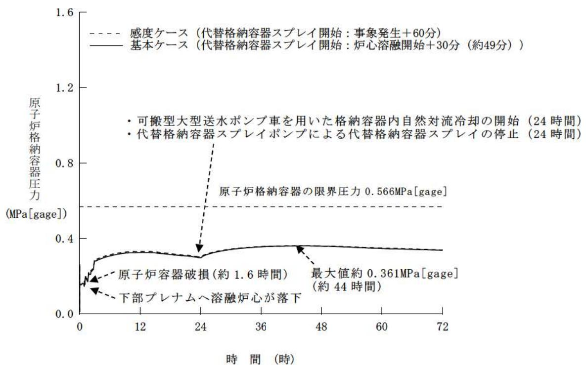
第 7.2.1.1.28 図 原子炉格納容器圧力の推移
