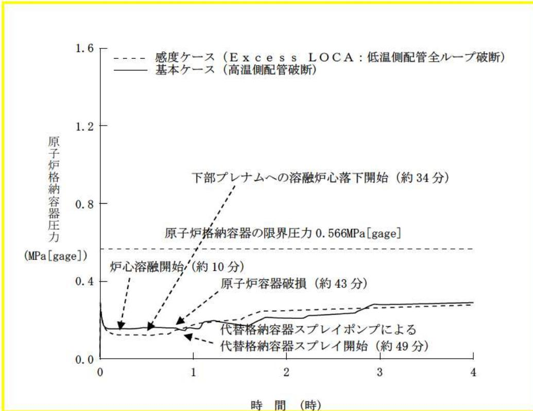
図 7 原子炉格納容器圧力の推移
