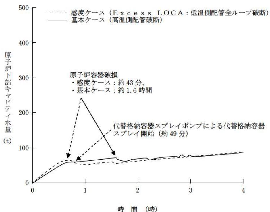
図8 原子炉下部キャビティ水量の推移
