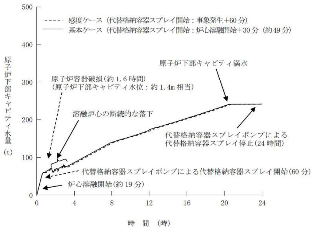
図3 原子炉下部キャビティ水量の推移
