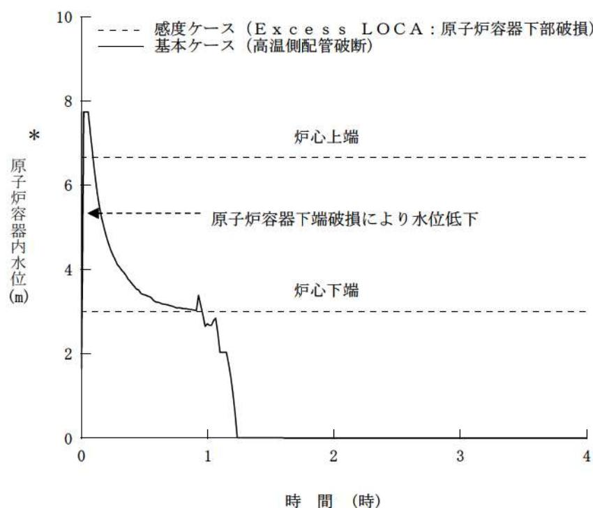
\* : 1次冷却材低温側配管下端を上限とした気泡水位を表示
