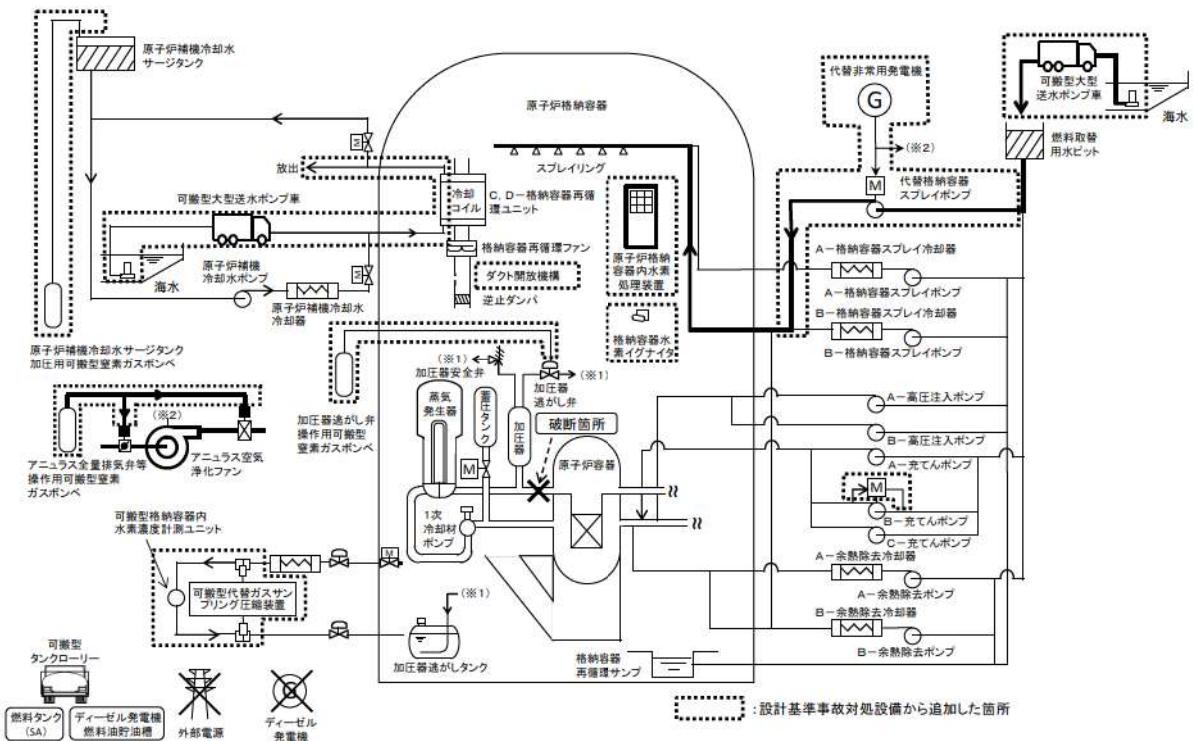
第 7.2.1.1.1 図 「霧囲気圧力・温度による静的負荷（格納容器過圧破損）」
