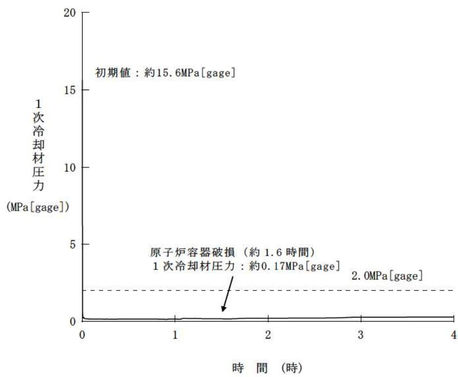
第 7.2.1.1.6 図 1 次冷却材圧力の推移
