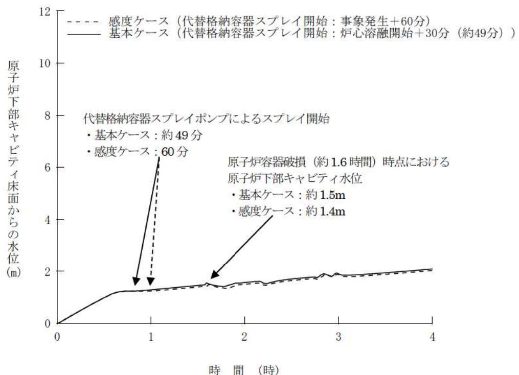
図4 原子炉下部キャビティ床面からの水位の推移
