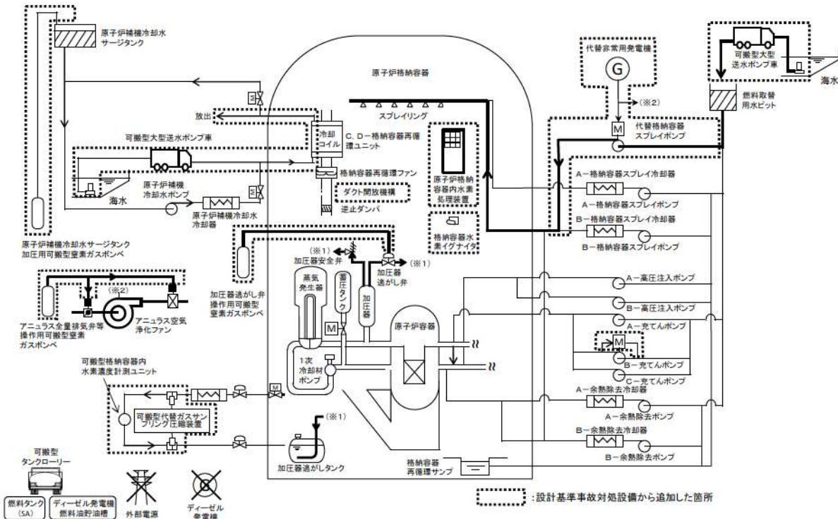
第 7.2.1.2.1 図 「雰囲気圧力・温度による静的負荷（格納容器過温破損）」
