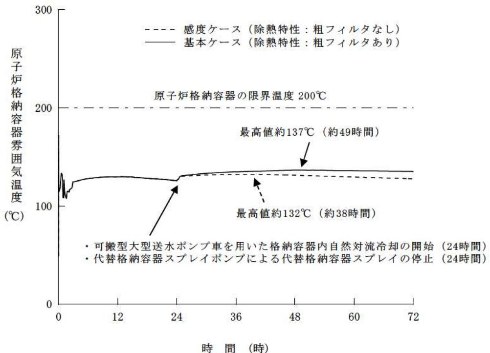
第 7.2.1.1.25 図 原子炉格納容器雰囲気温度の推移
