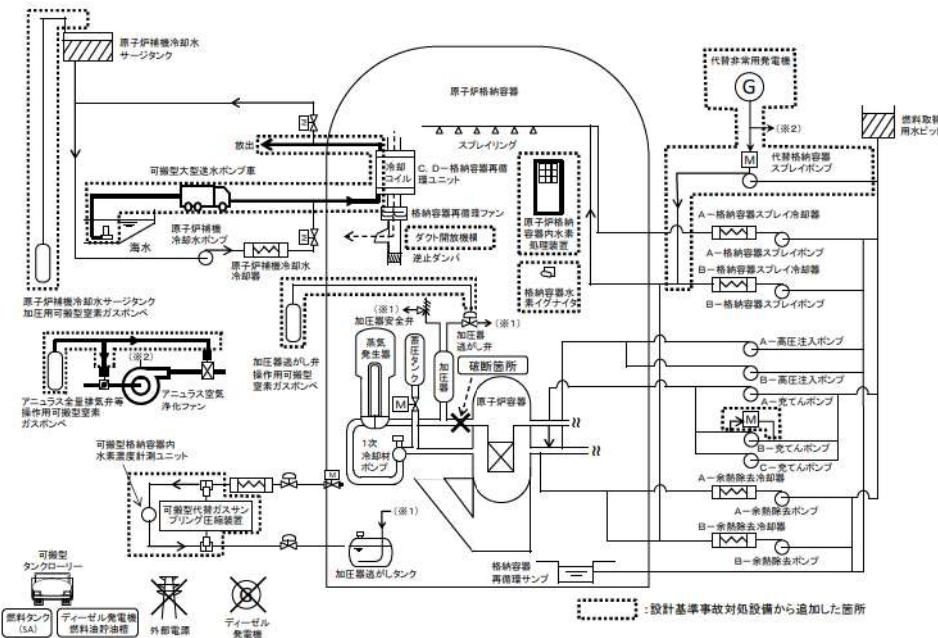
図 2 「大破断 LOCA 時に低圧注入機能、高压注入機能及び格納容器スプレイ注入機能が喪失する事故」の重大事故等対策の概略系統図
