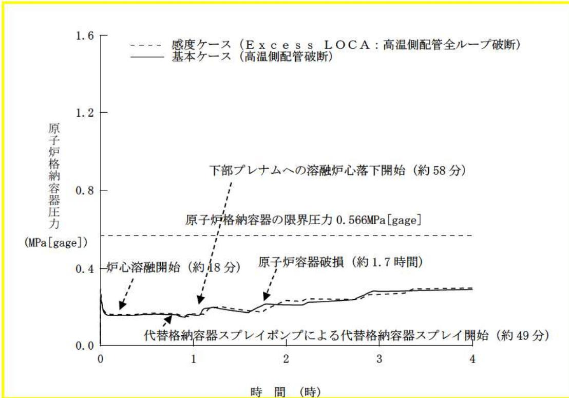
図2 原子炉格納容器圧力の推移
