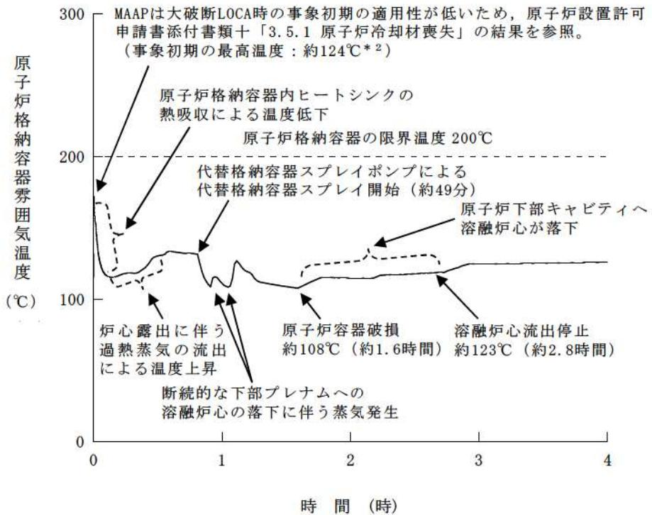
\* 1 : 原子炉格納容器雰囲気温度の推移はMAAPによる解析結果を示している
