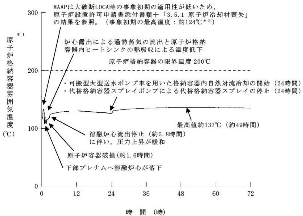
\* 1 : 原子炉格納容器雰囲気温度の推移はMAAPによる解析結果を示している
