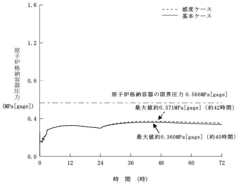
第 7.2.1.1.26 図 原子炉格納容器圧力の推移
