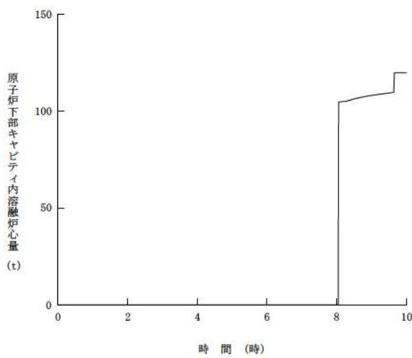
図7 原子炉下部キャビティ内溶融炉心量の変化（格納容器過温破損）
