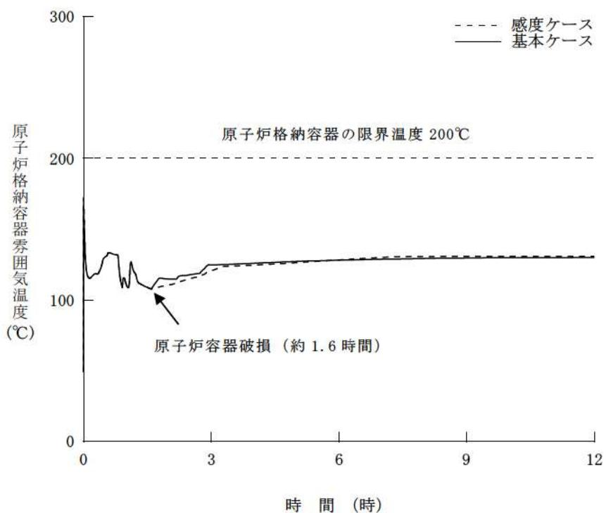
第 7.2.1.1.17 図 原子炉格納容器雰囲気温度の推移
