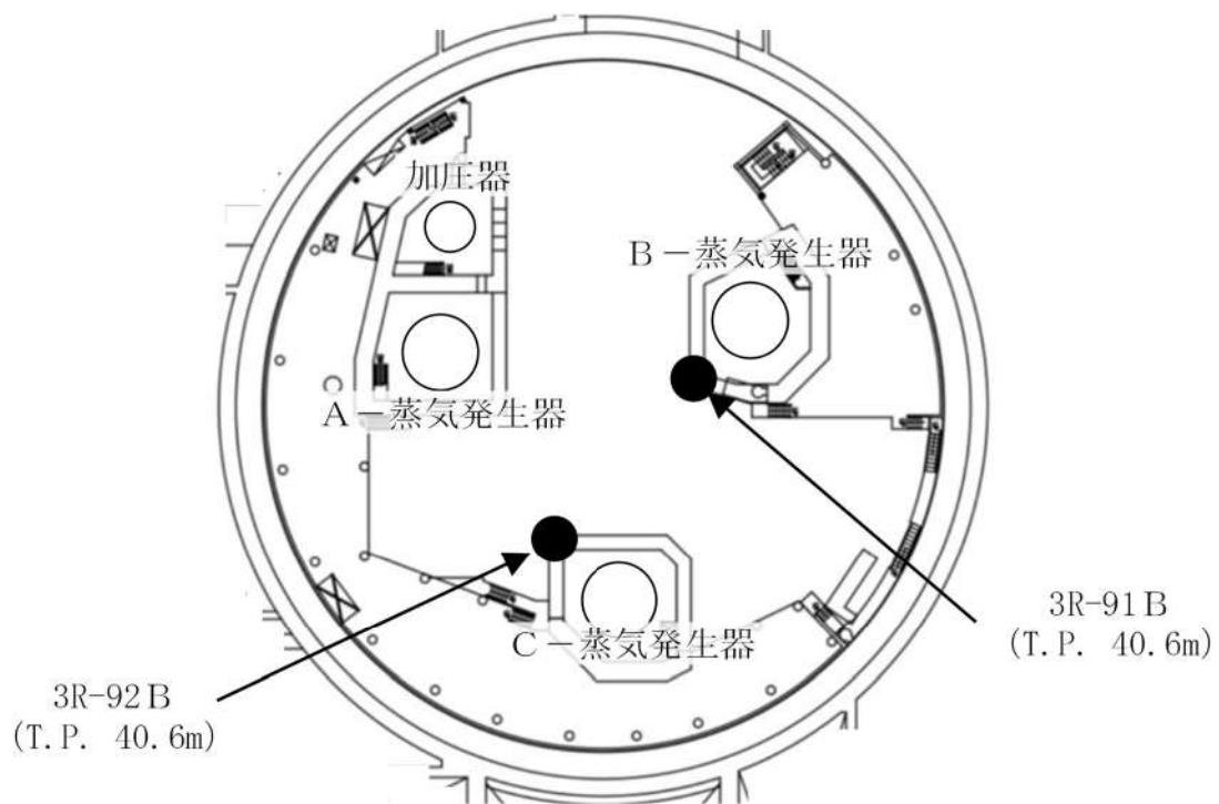
● : 格納容器内高レンジエリアモニタ（高レンジ）の設置箇所（2 箇所）
