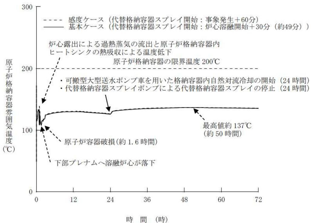
図2 原子炉格納容器雰囲気温度の推移
