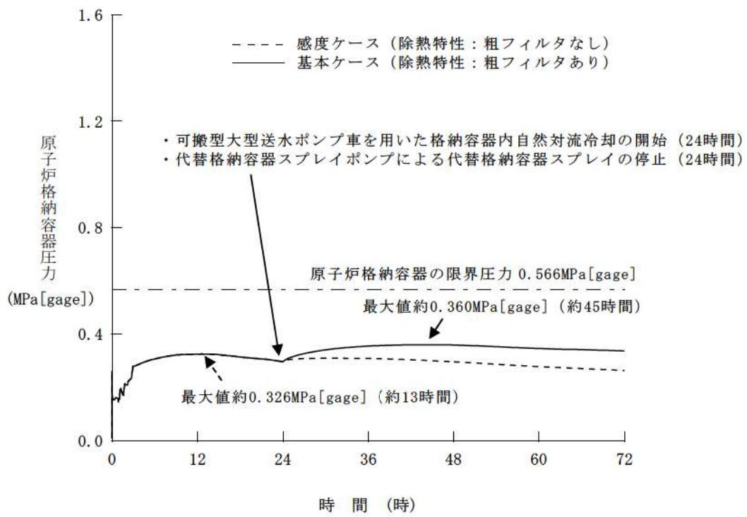
第 7.2.1.1.24 図 原子炉格納容器圧力の推移
