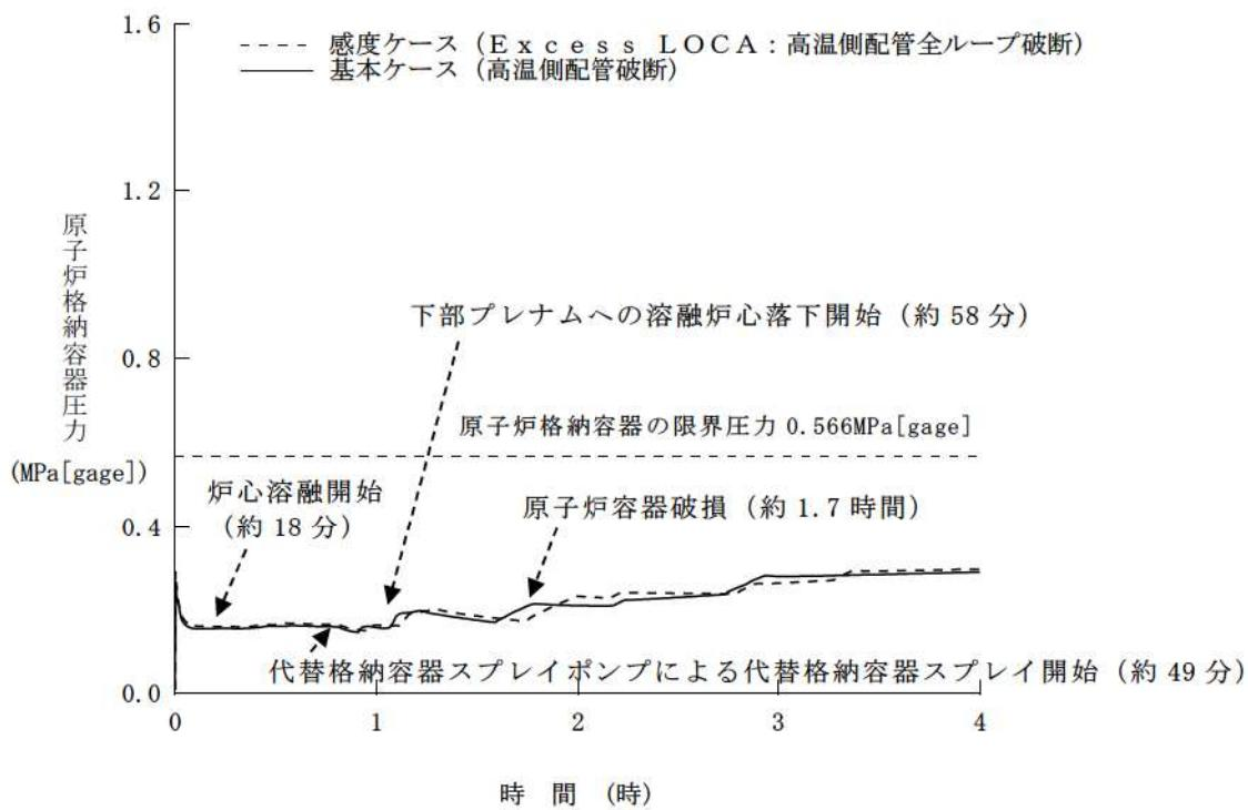
第 7.2.1.1.19 図 原子炉格納容器圧力の推移
