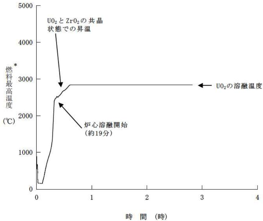
\* : 炉心ノードにおける最高の燃料温度
