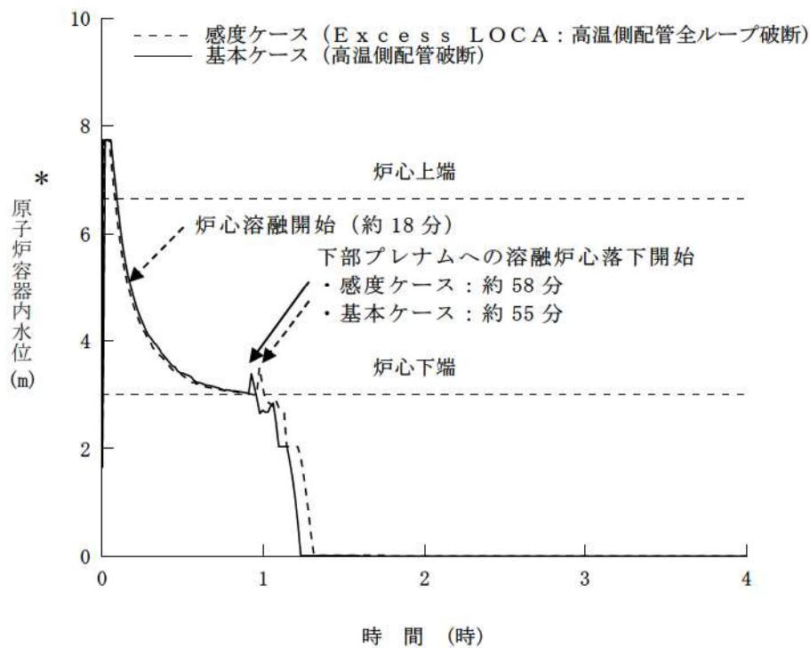
\* : 1次冷却材低温側配管下端を上限とした気泡水位を表示
