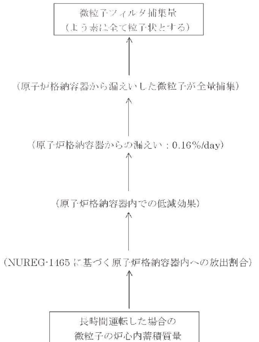
図1 アニュラス空気浄化設備の微粒子フィルタ捕集量評価の過程
