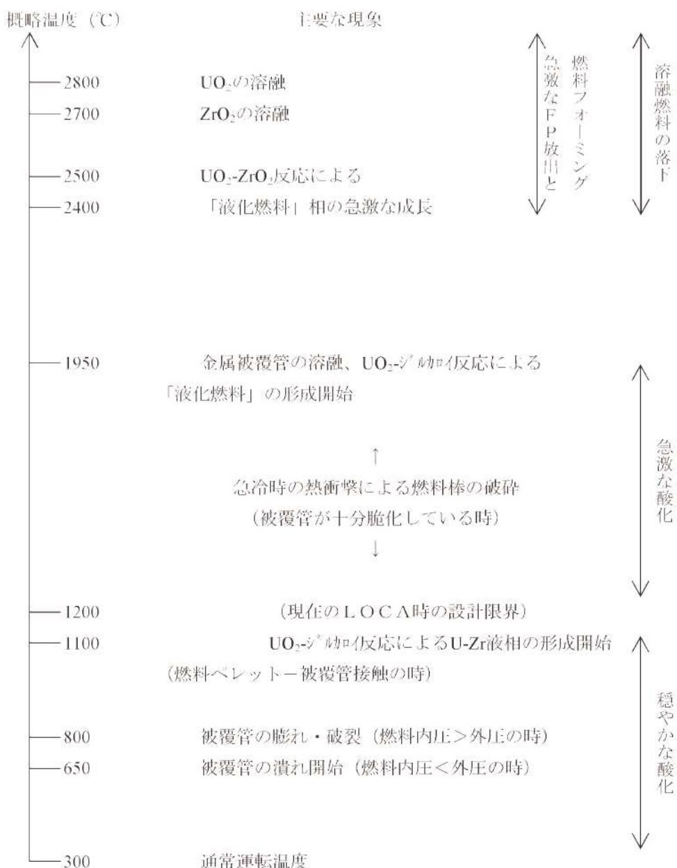
図 1 燃料棒の温度応答概略図<sup>[1]</sup>
