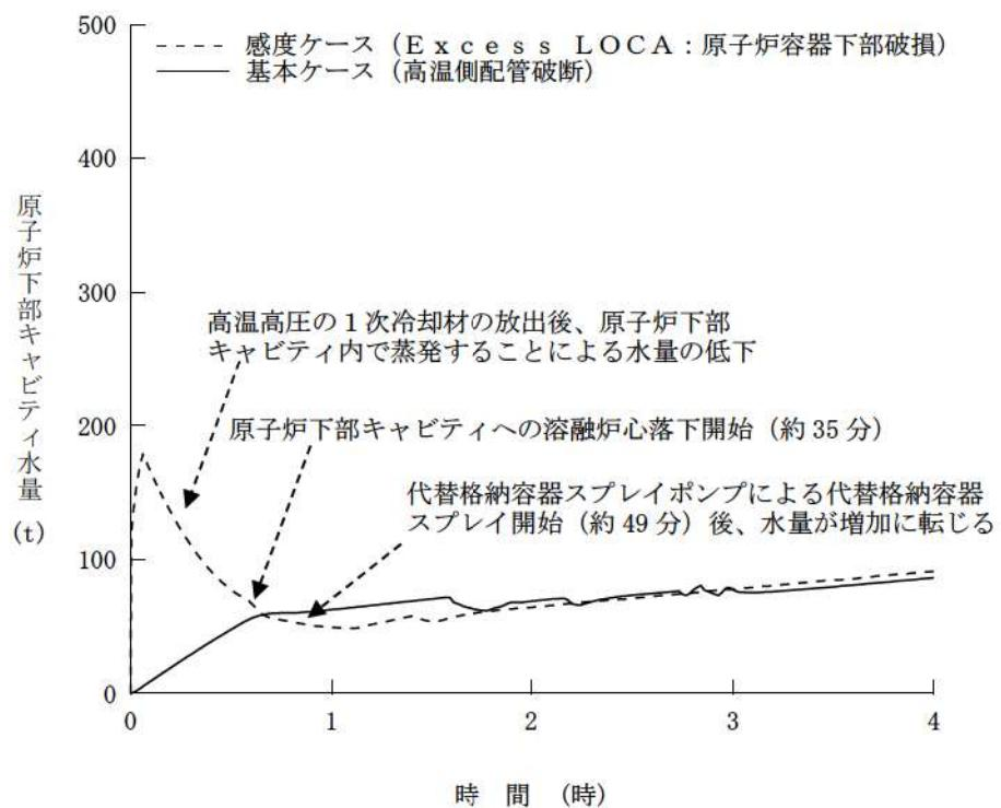
図 13 原子炉下部キャビティ水量の推移
