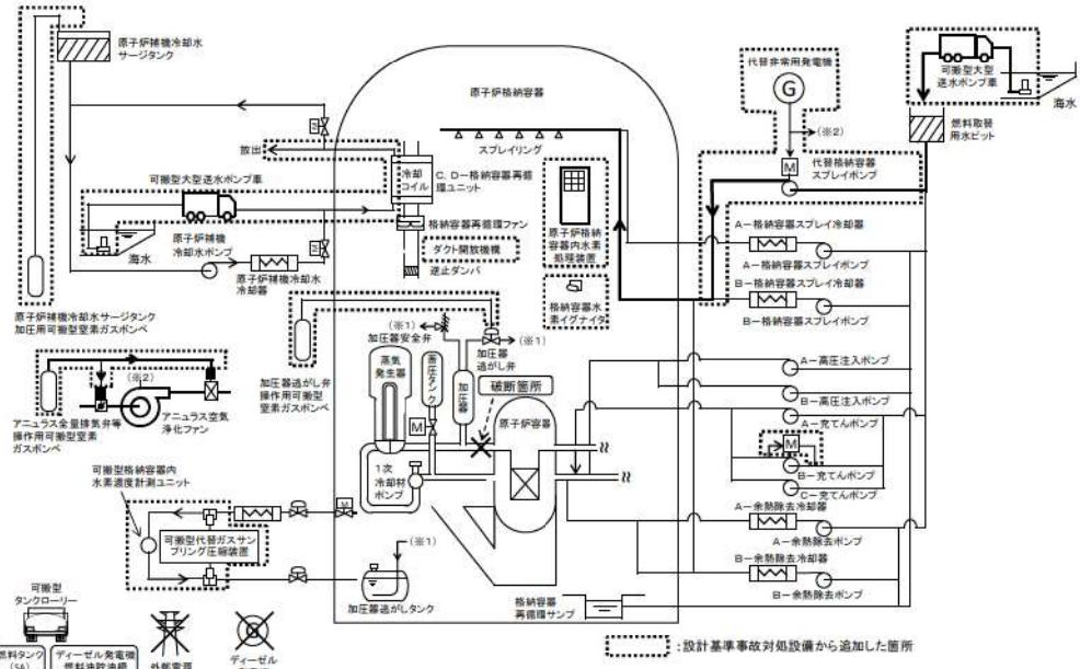
図 1 「大破断 LOCA 時に低圧注入機能、高压注入機能及び格納容器スプレイ注入機能が喪失する事故」の重大事故等対策の概略系統図
