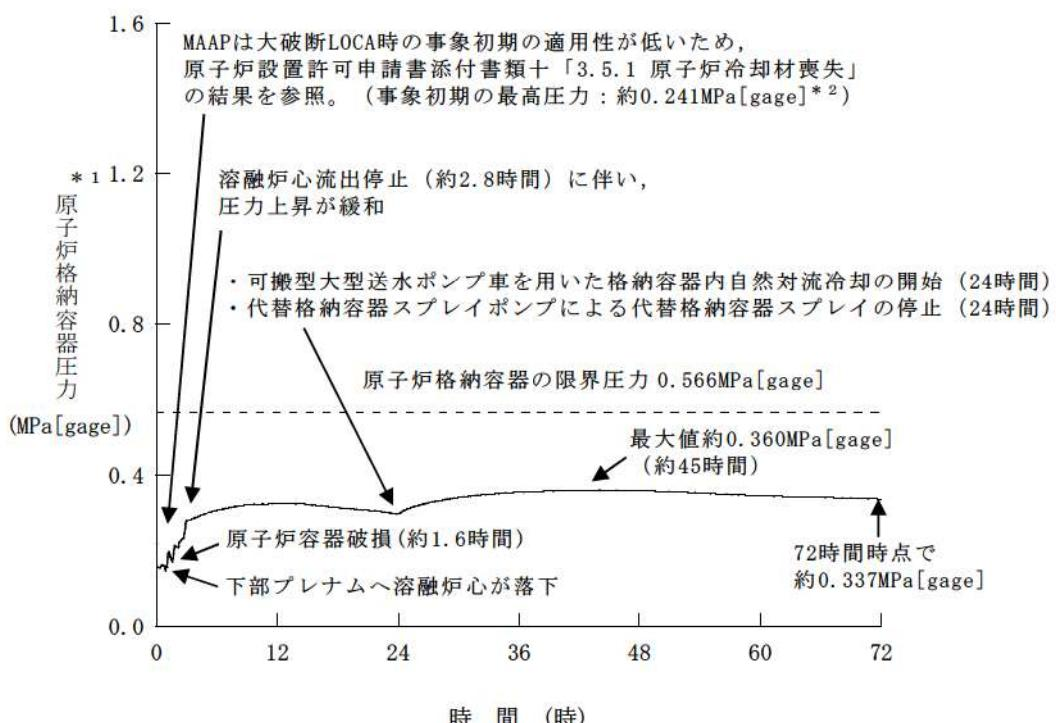
\* 1 : 原子炉格納容器圧力の推移はMAAPによる解析結果を示している
