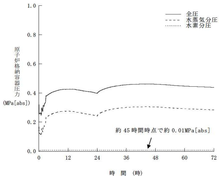
第 7.2.1.1.13 図 原子炉格納容器圧力に占める水蒸気及び水素の分圧
