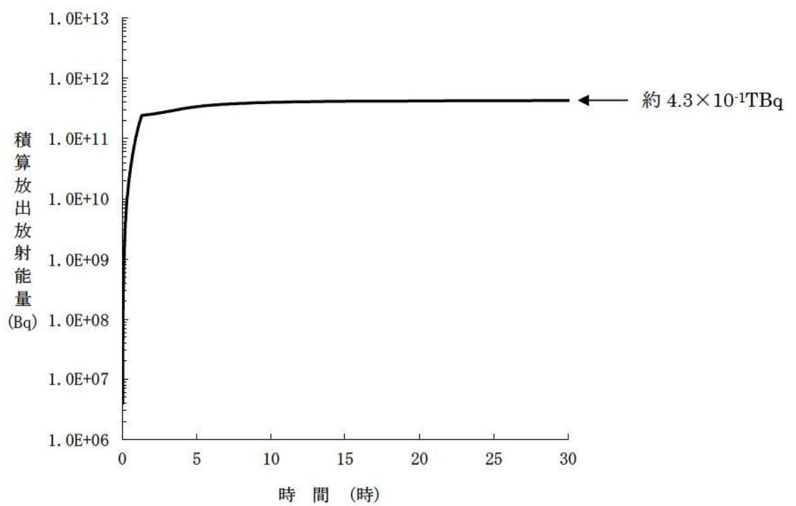
図5 Cs-137 積算放出放射能量の推移（30時間）
