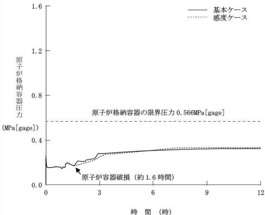
図1 原子炉格納容器圧力の推移
