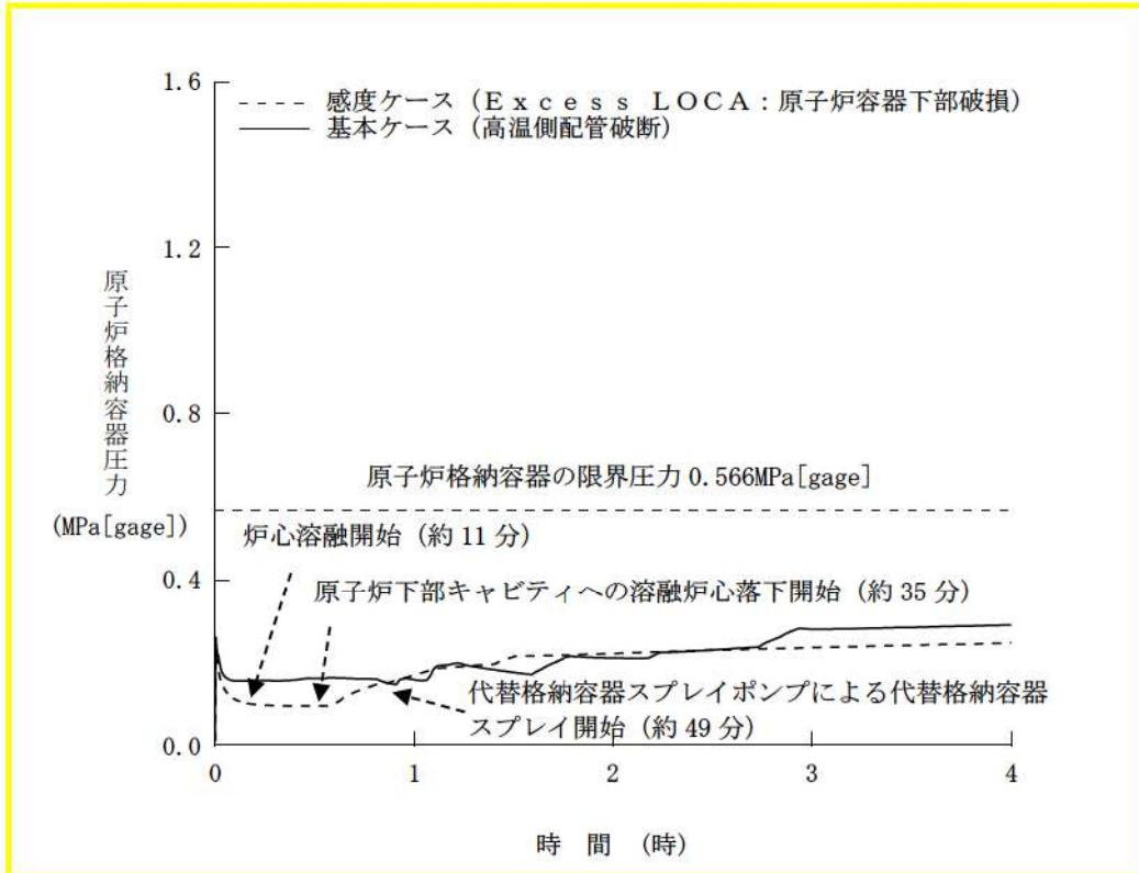
図 12 原子炉格納容器圧力の推移
