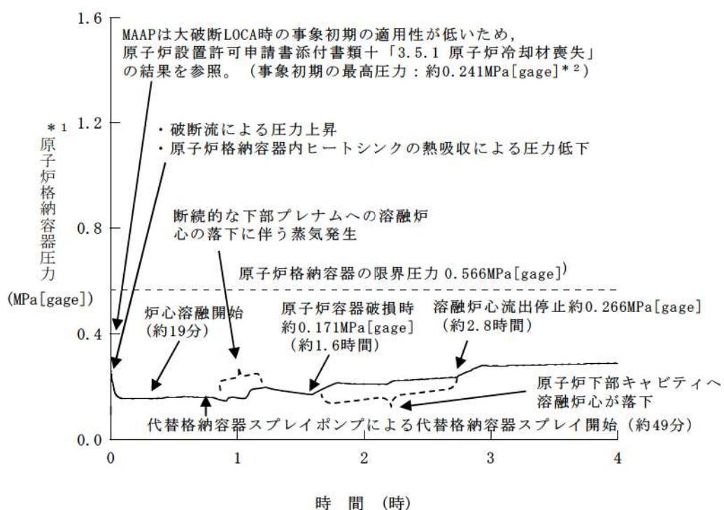
\* 1 : 原子炉格納容器圧力の推移はMAAPによる解析結果を示している
