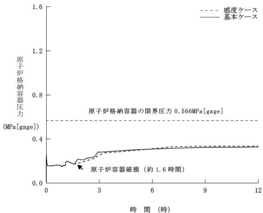
第 7.2.1.1.16 図 原子炉格納容器圧力の推移
