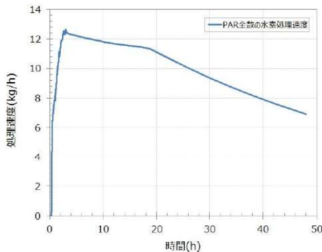
図 2 PAR 5 個による水素処理速度の推移
