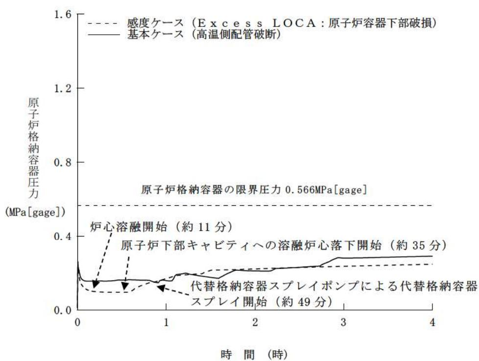
第 7.2.1.1.23 図 原子炉格納容器圧力の推移
