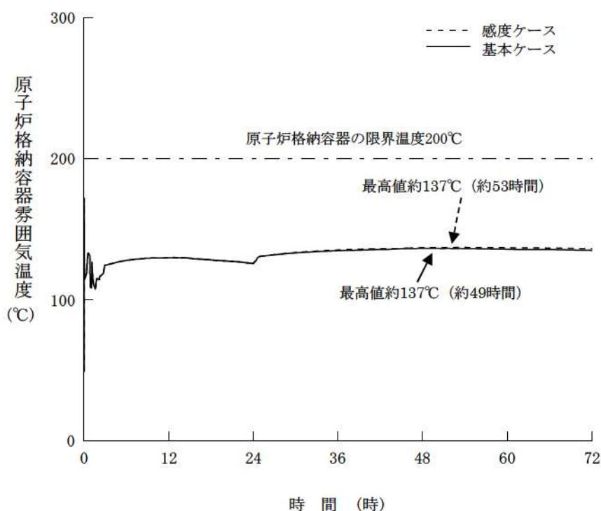
図2 原子炉格納容器雰囲気温度の推移
