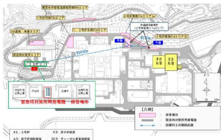
図4-10 緊急時対策所用発電機の保管場所
