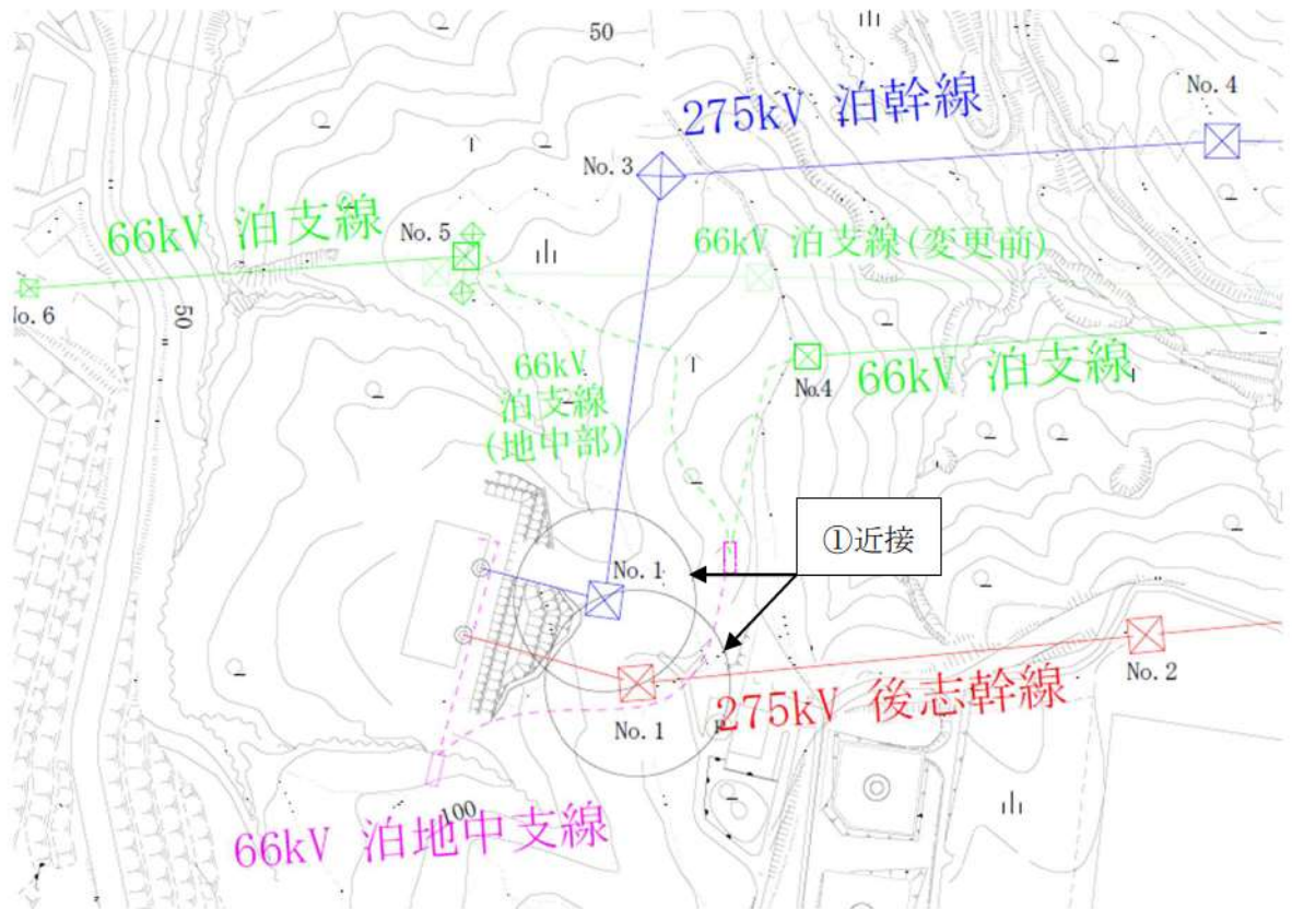
第 2. 2. 3. 3 図 ①近接箇所の現地状況 (3/3)
