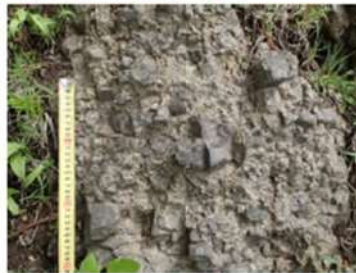
P6 防災科研調査において地滑り土塊北側端部とされる箇所付近の露岩状況 堅硬な岩盤（凝灰角礫岩）が認められる。
