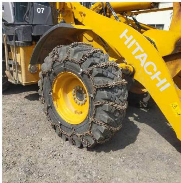
第4-3図 重機の凍結路面の滑り防止対策
