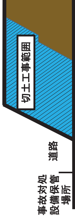
切土工事イメージ(側面図)
