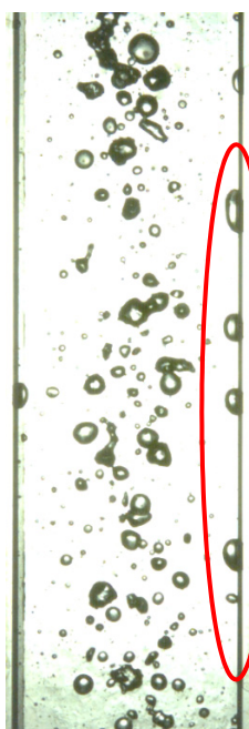
(a) 従来の流路（端部からの発生気泡が流入）
