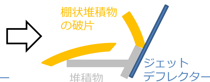
ジェットデフレクター面の堆積物分布 (現状)
