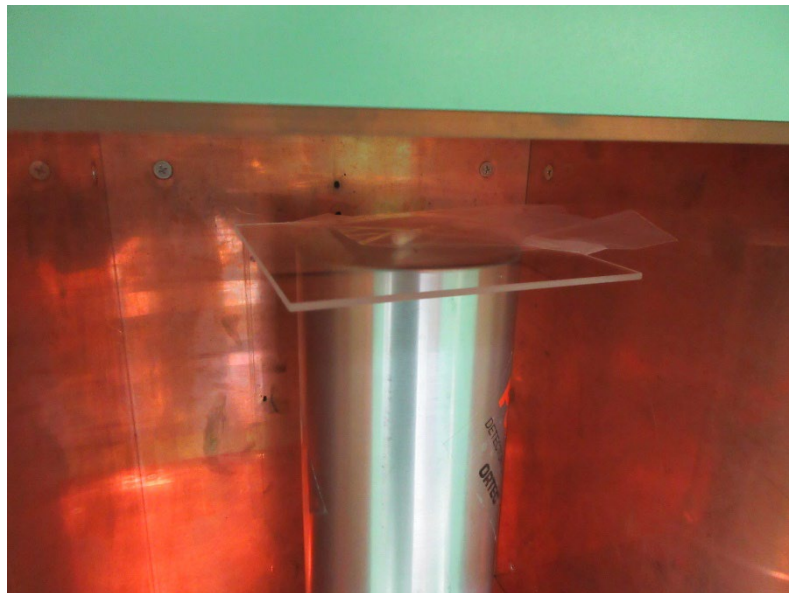
図-5. 20 : ガンマ線測定用試料台への固定(上)と測定の様子(下)
