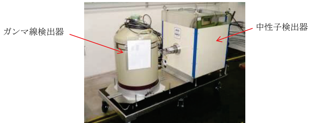
写真 1.1-2 AVIS の外観写真
