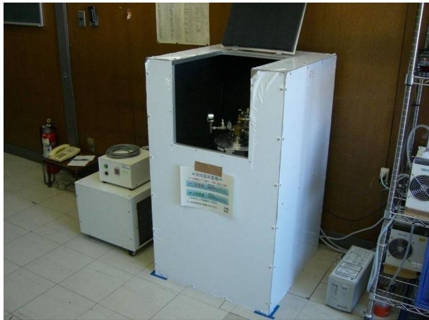
図 3-8-1(2) 大気中の希ガス捕集装置
