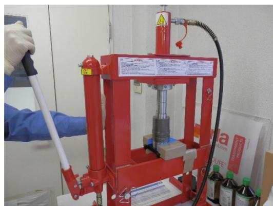
図 2-2-9 測定試料成型用のプレス機
