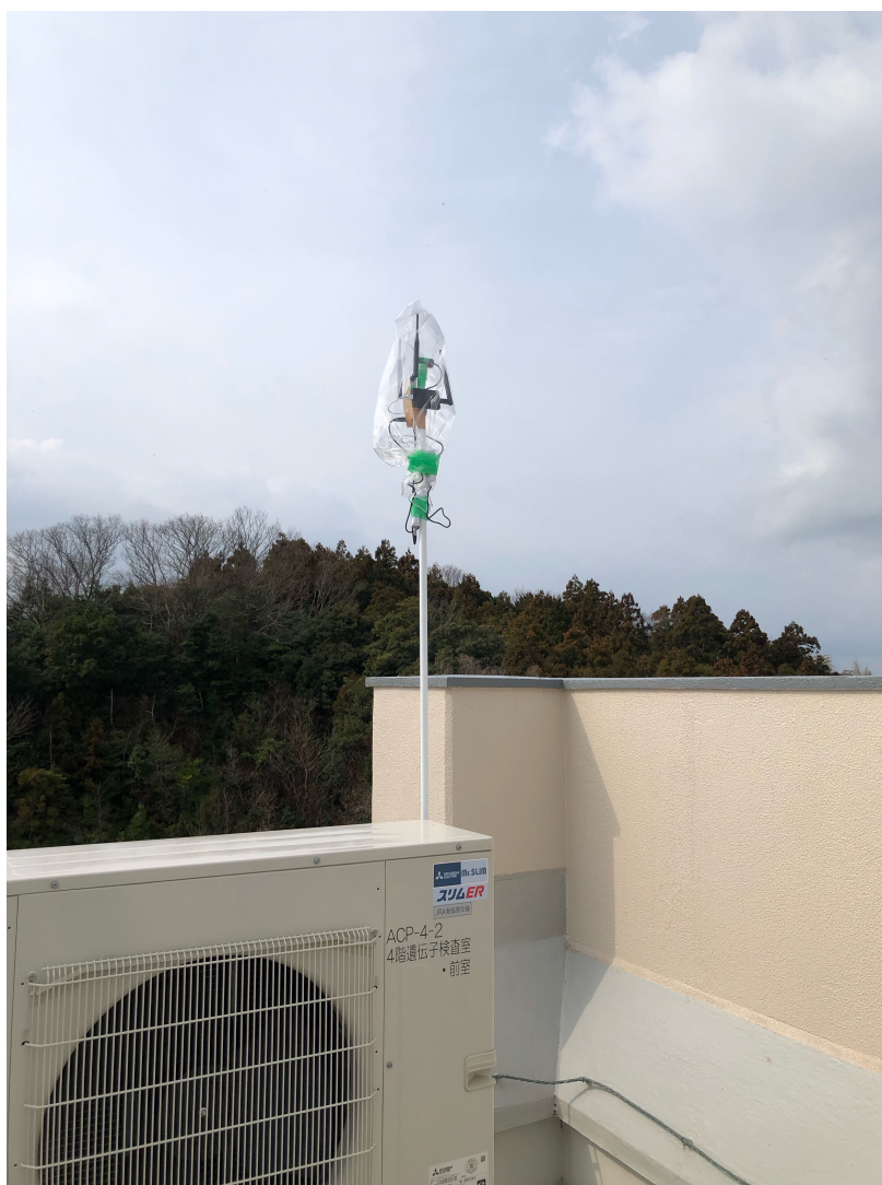
図 10 保健環境研究所屋上に設置した中継局の様子。地上高約 20 m である。
