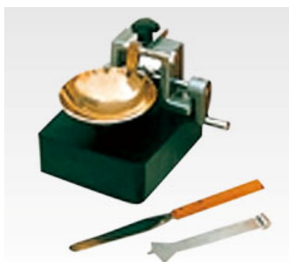
写真-3.3 液性限界試験の使用機器例
