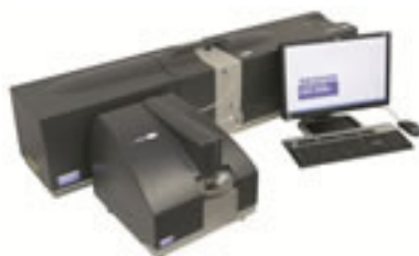
写真- 3.1 レーザ回折・散乱式粒度分布測定器：LMS-2000e
