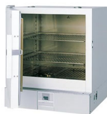
(b) 試料乾燥：定温乾燥器
