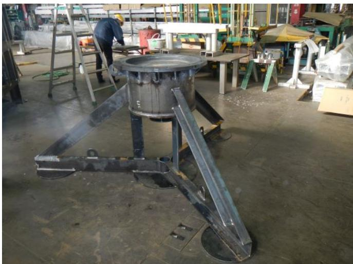
図 2-2-32. 海底地盤変動観測装置 GNSS アンテナ台（倒立状態）
