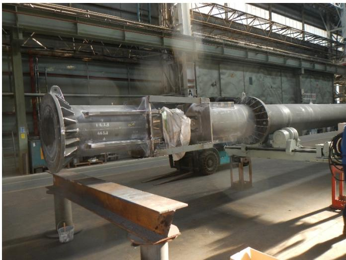
図 2-2-36. 海底地盤変動観測装置ユニバーサルジョイント。上下端四隅に仮止め材をつけた状態を示す。仮止め材は納品時に撤去された。
