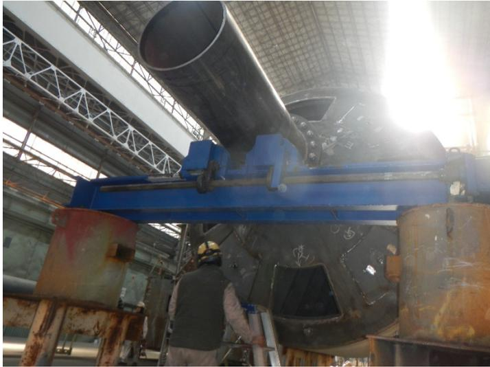
図 2-2-35. 海底地盤変動観測装置浮力体（気密検査中）
