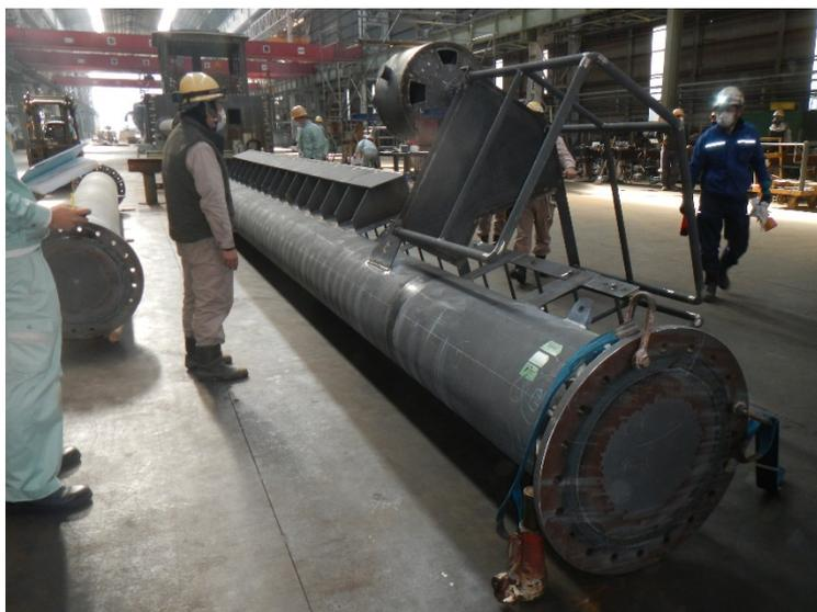
図 2-2-34. 海底地盤変動観測装置上部鋼管最上部
