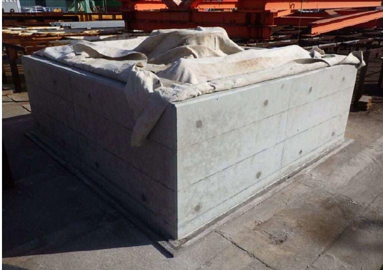
図 2-2-37. 海底地盤変動観測装置アンカー（日立造船提供）
