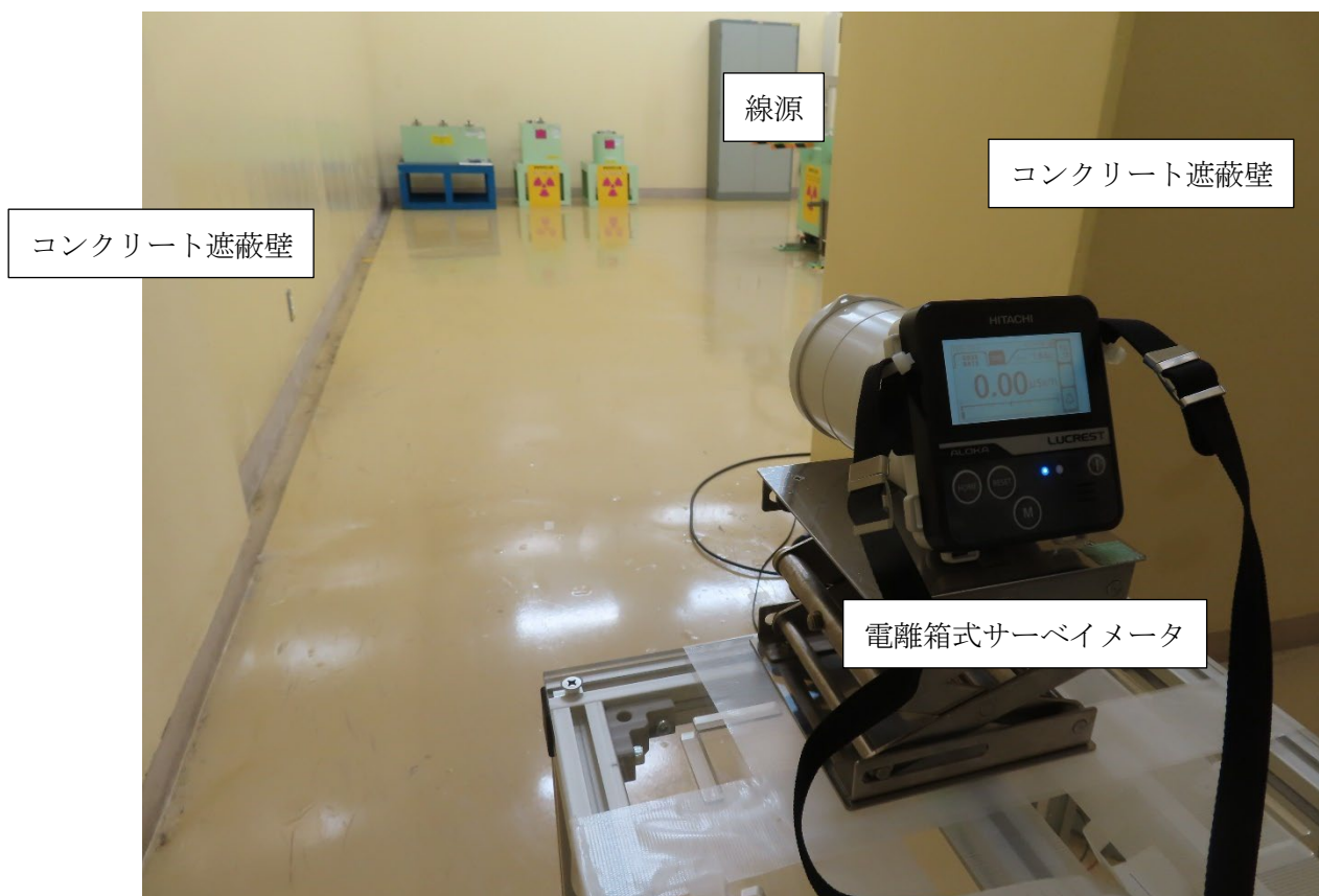
図 4-1-4-4 H 社製電離箱式サーベイメータを用いた直接測定時の様子
