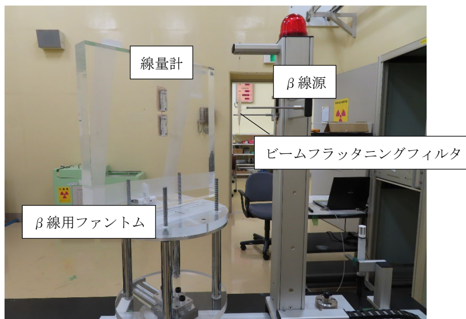
図 4-68 D社製受動形個人線量計（体幹部用）の \beta 線に対する特性試験の様子
