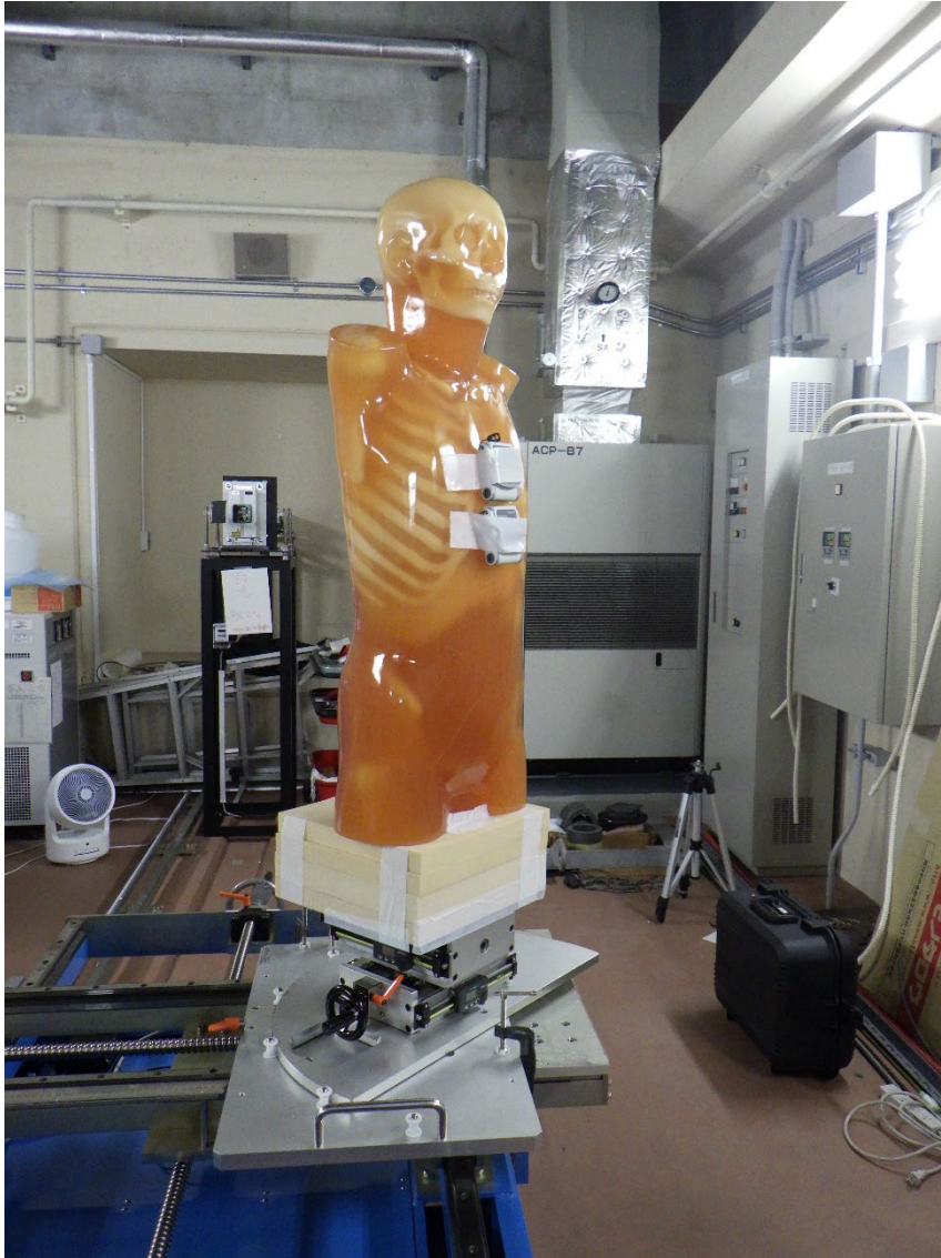
図 3.2.2-3 人体模擬ファントムでの照射試験（45 度）
