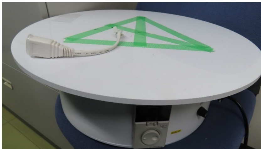
図 4-4 5 ROT 照射試験に用いた回転台
