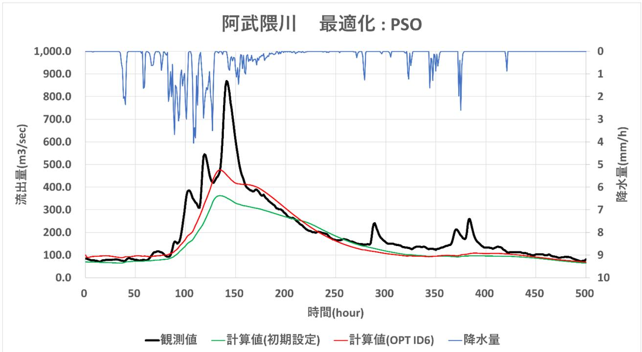
図 4-18 流出量時刻歴、PSO 法最適化、阿武隈川、対象：(透水係数、粗度係数、間隙率)
