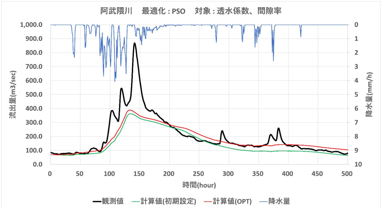
図 4-27 流出量時刻歴、SCE-UA 法最適化、阿武隈川、対象 : (透水係数、間隙率)
