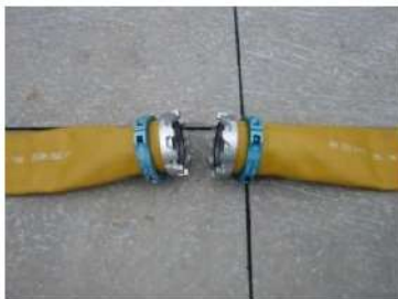
可搬型ホース (150A) 接続前
