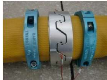
可搬型ホース (150A) 接続後
