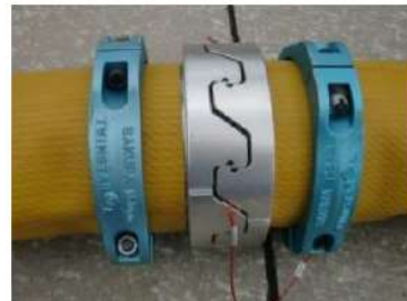
可搬型ホース（150 A）接続後
