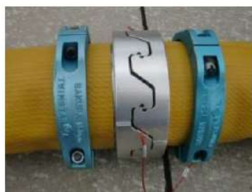
可搬型ホース(150A) 接続後
