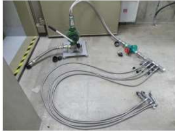
専用工具（タービン動補助給水ポンプ潤滑油供給器） （タービン動補助給水ポンプ室に保管）
