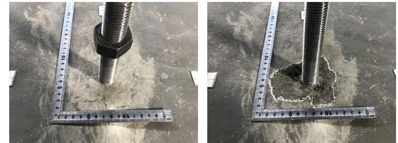
(ひび割れ箇所除去前) (ひび割れ箇所除去後) 引張試験後の状況写真
