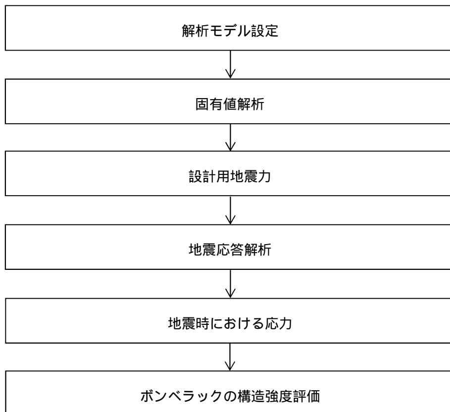
図2 - 1 ボンベラックの耐震評価フロー
