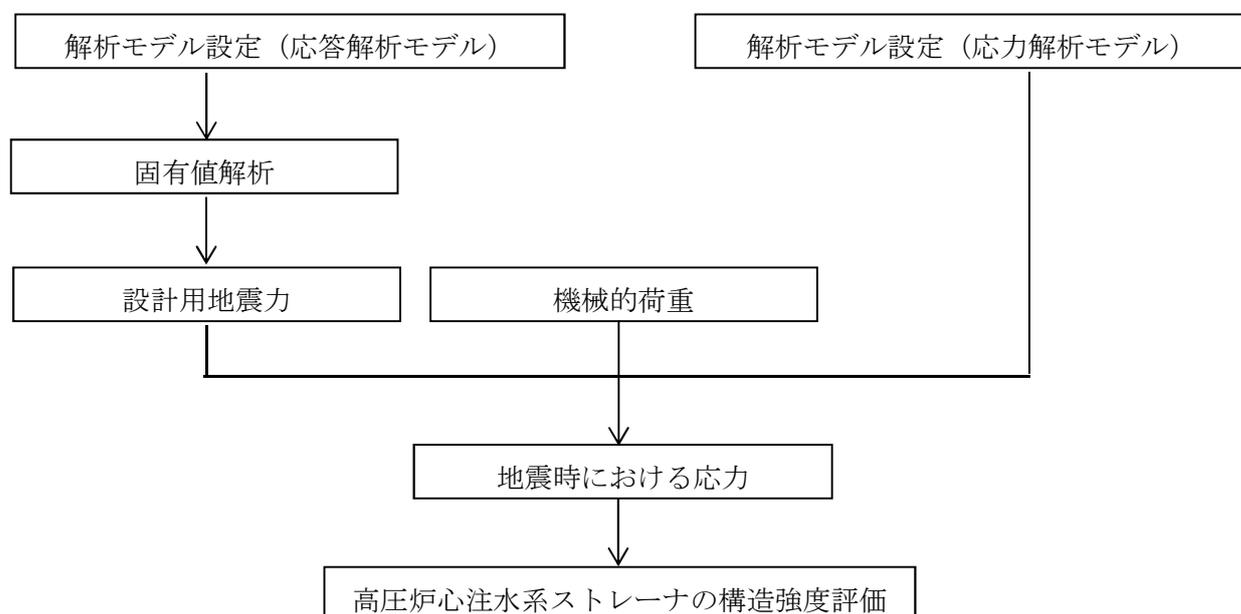
図2-1 高圧炉心注水系ストレーナの耐震評価フロー
