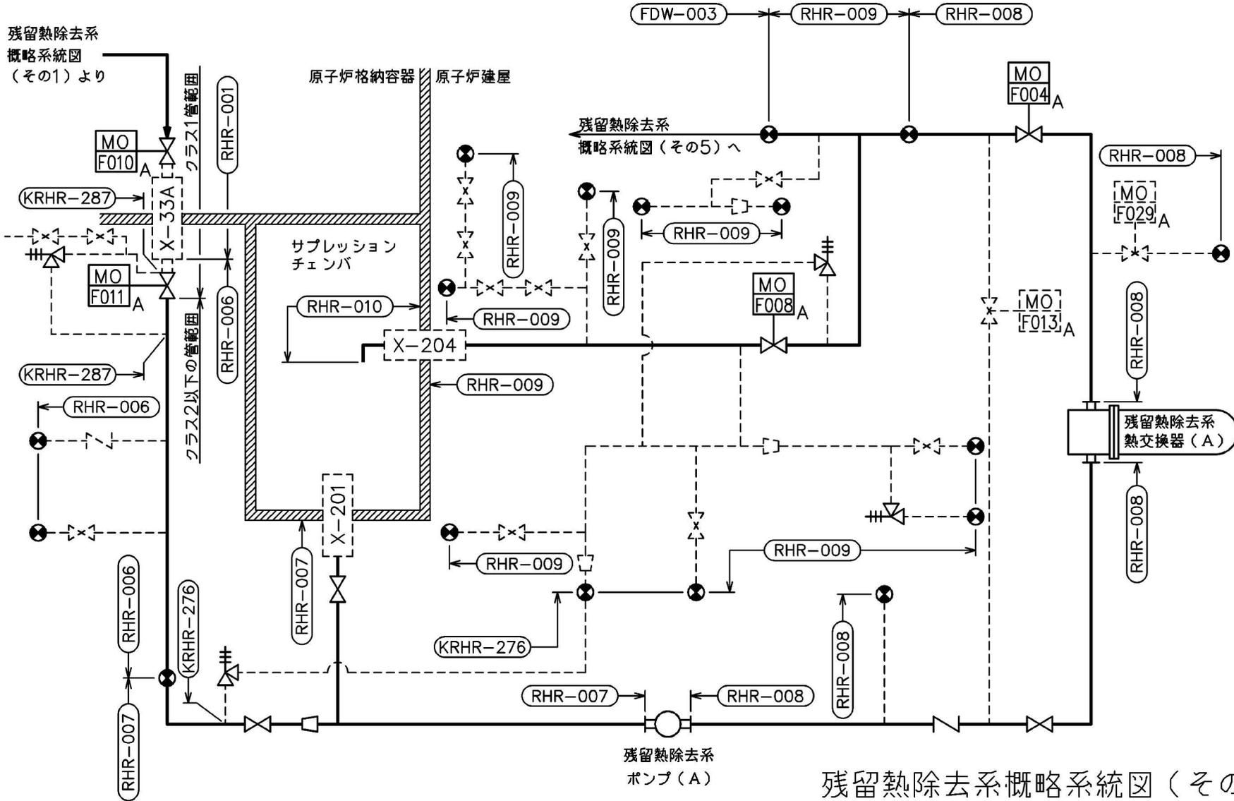
残留熱除去系概略系統図 (その2)
