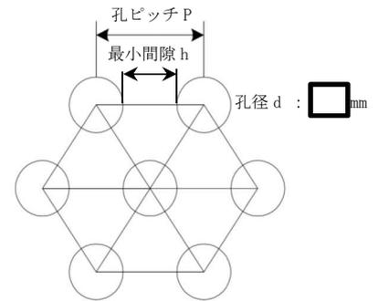
図 4-9 多孔プレートの孔寸法
