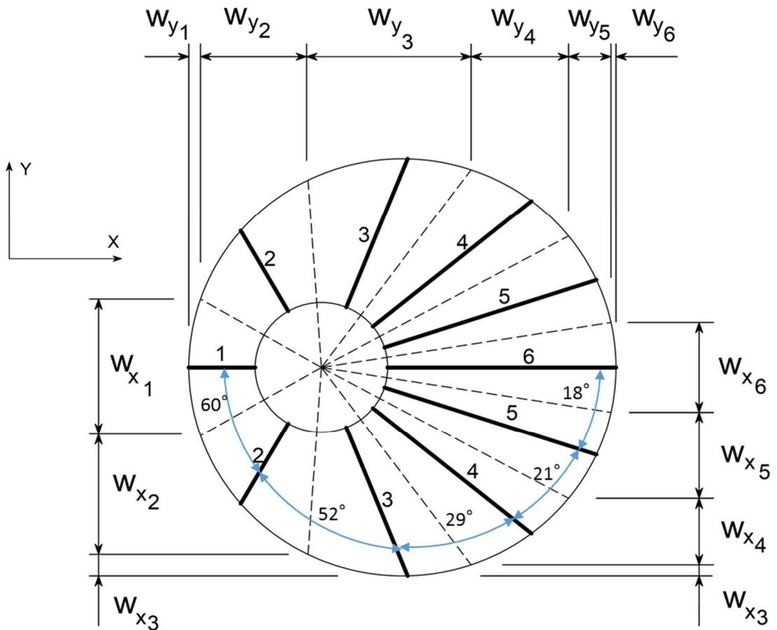
添付図 1 ラジアル補剛材の配置諸元
