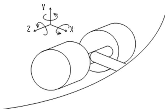
図 4-5 ストレーナに加わる荷重方向
