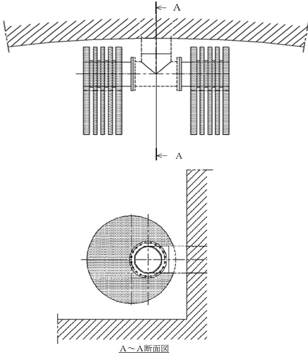
図 3-1 高圧炉心注水系ストレーナの取付状況
