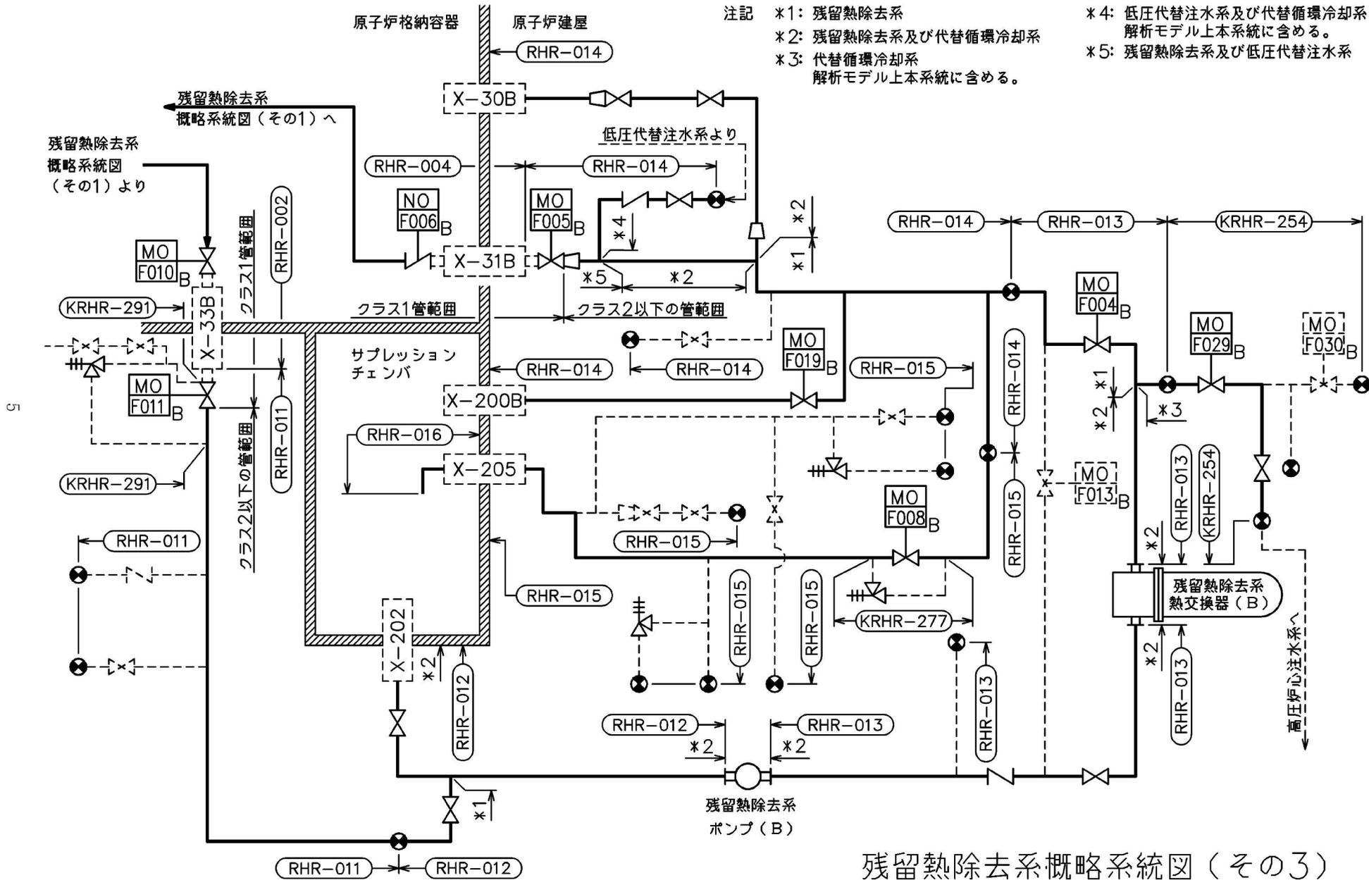
残留熱除去系概略系統図 (その3)
