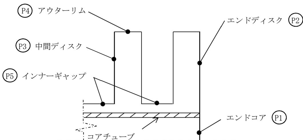
図 4-2 多孔プレートの応力評価点
