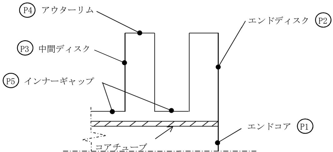
図 4-3 多孔プレートの応力評価点
