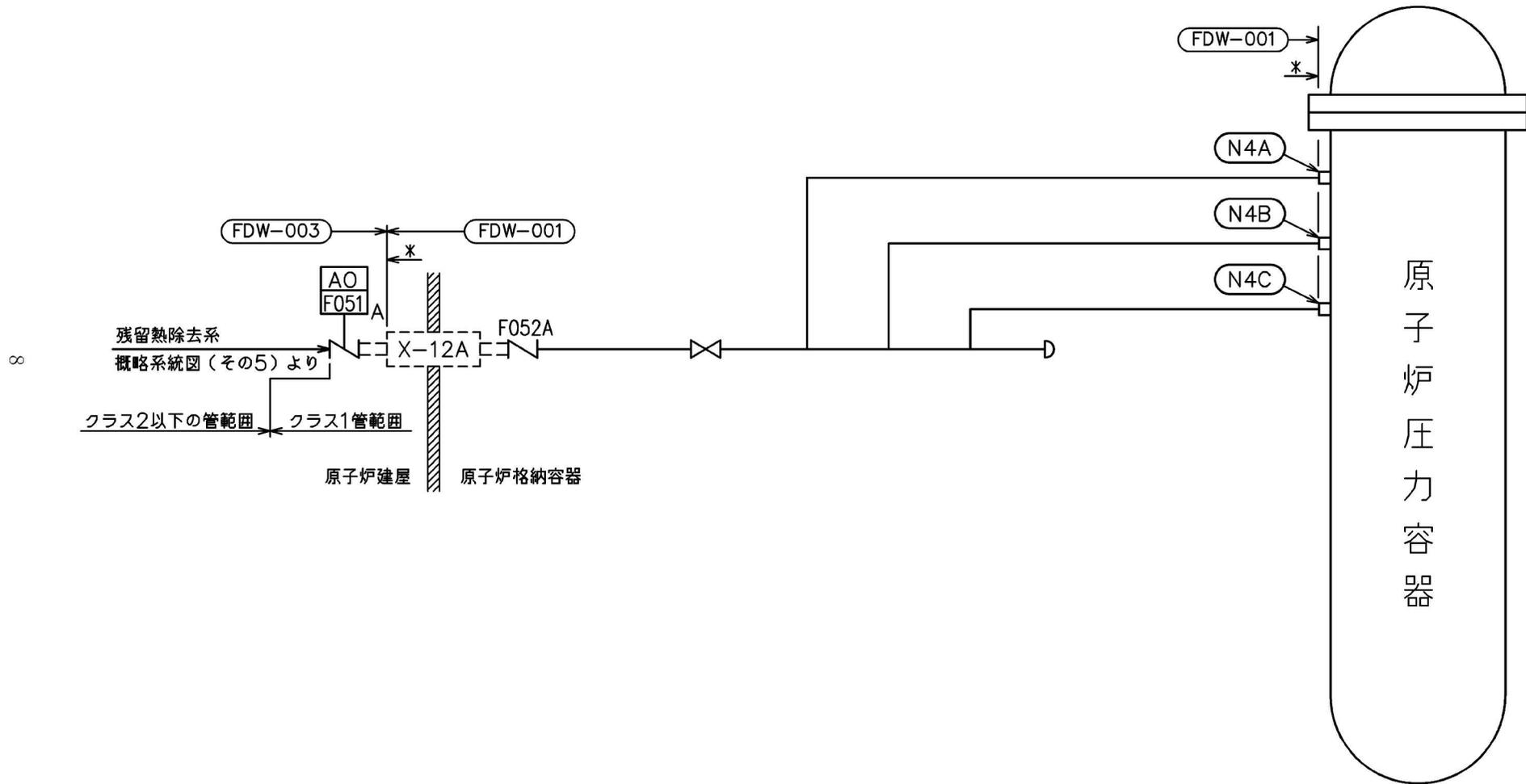
残留熱除去系概略系統図(その6)
