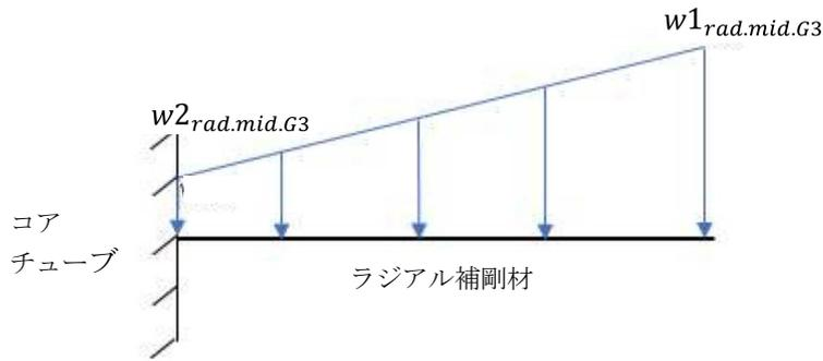
図4-8 中間ディスクのラジアル補剛材の荷重状態
