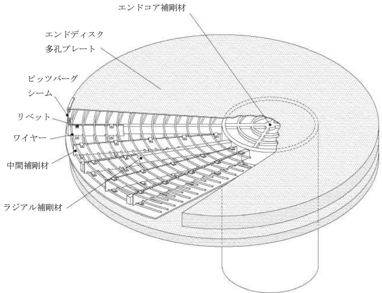
図 3-3 高圧炉心注水系ストレーナの構造概要
