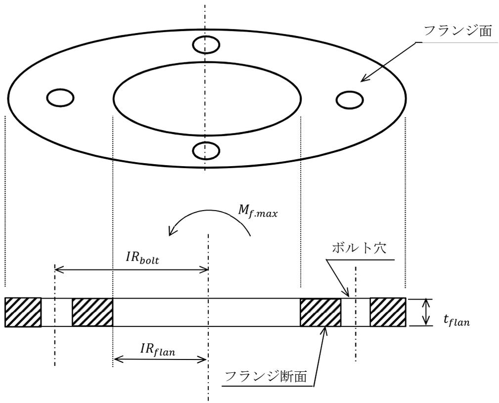
図 4-14 フランジ断面の計算モデル
