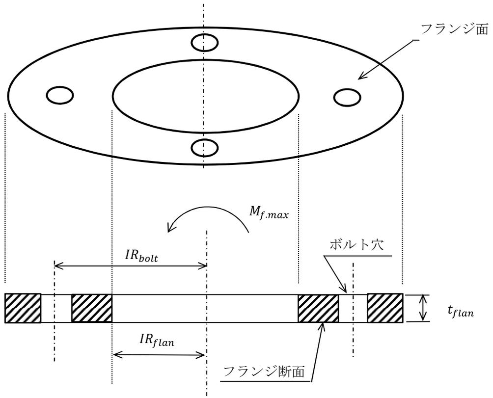
図 4-15 フランジ断面の計算モデル
