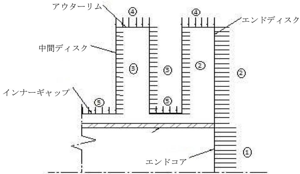
図4-5 多孔プレートの各応力評価部位
