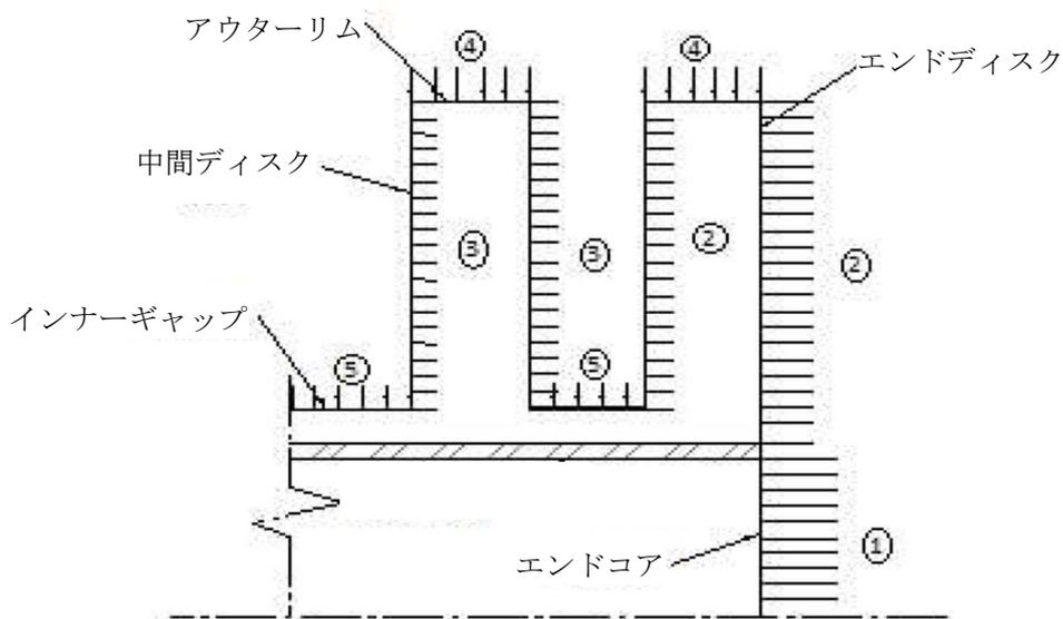
図4-4 多孔プレートの各応力評価部位
