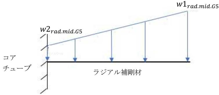
図 4-7 中間ディスクのラジアル補剛材の荷重状態
