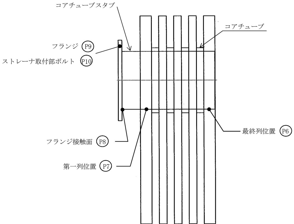
図 4-3 コアチューブ及びフランジ部の応力評価部位
