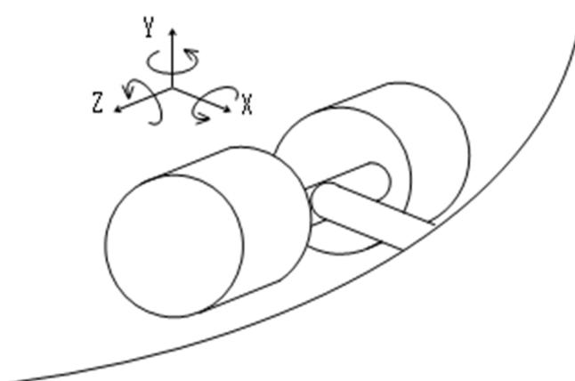
図4-6 ストレーナに加わる荷重方向
