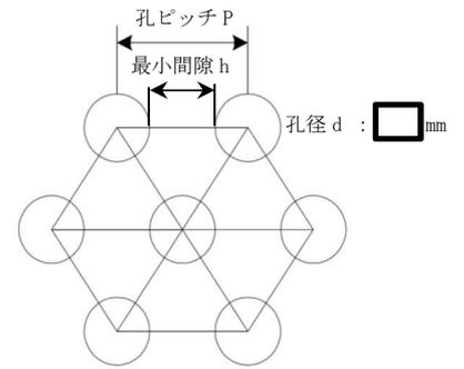
図 4-8 多孔プレートの孔寸法
