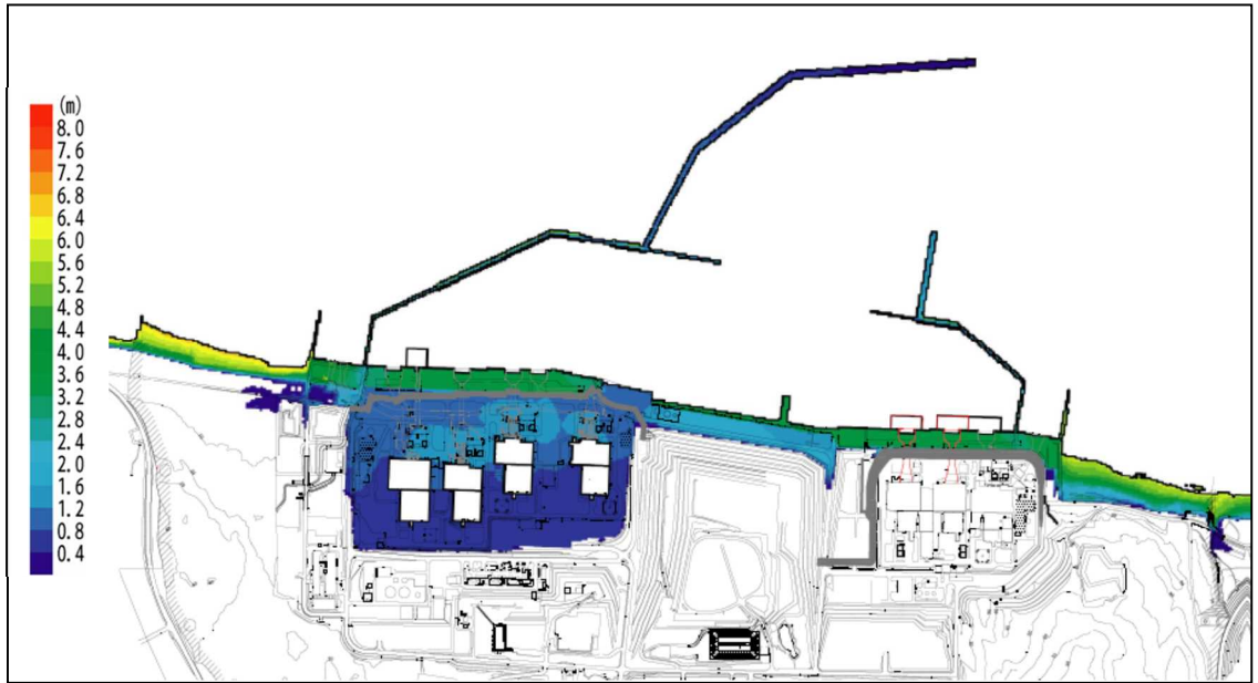
図 3-3(1) 基準津波による荒浜側防潮堤内敷地の最大浸水深分布
