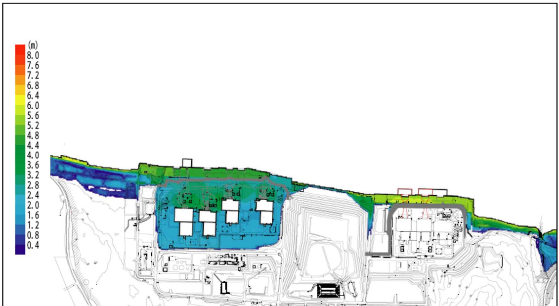
図 3-3(2) 基準津波による発電所全体遡上域の最大浸水深分布
