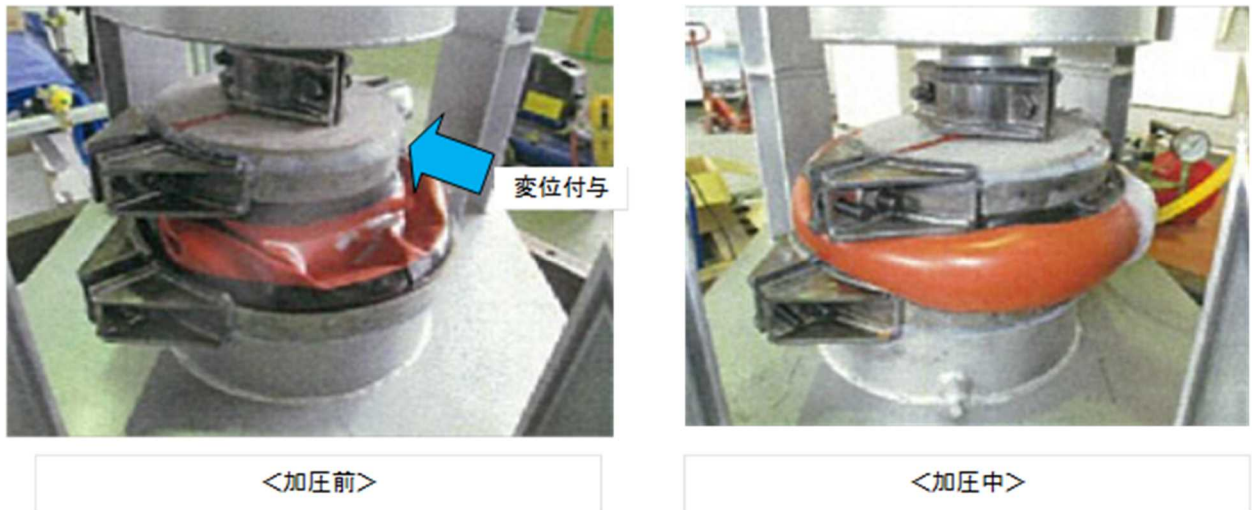
図4-5 漏えい試験概要図（ブーツ）
