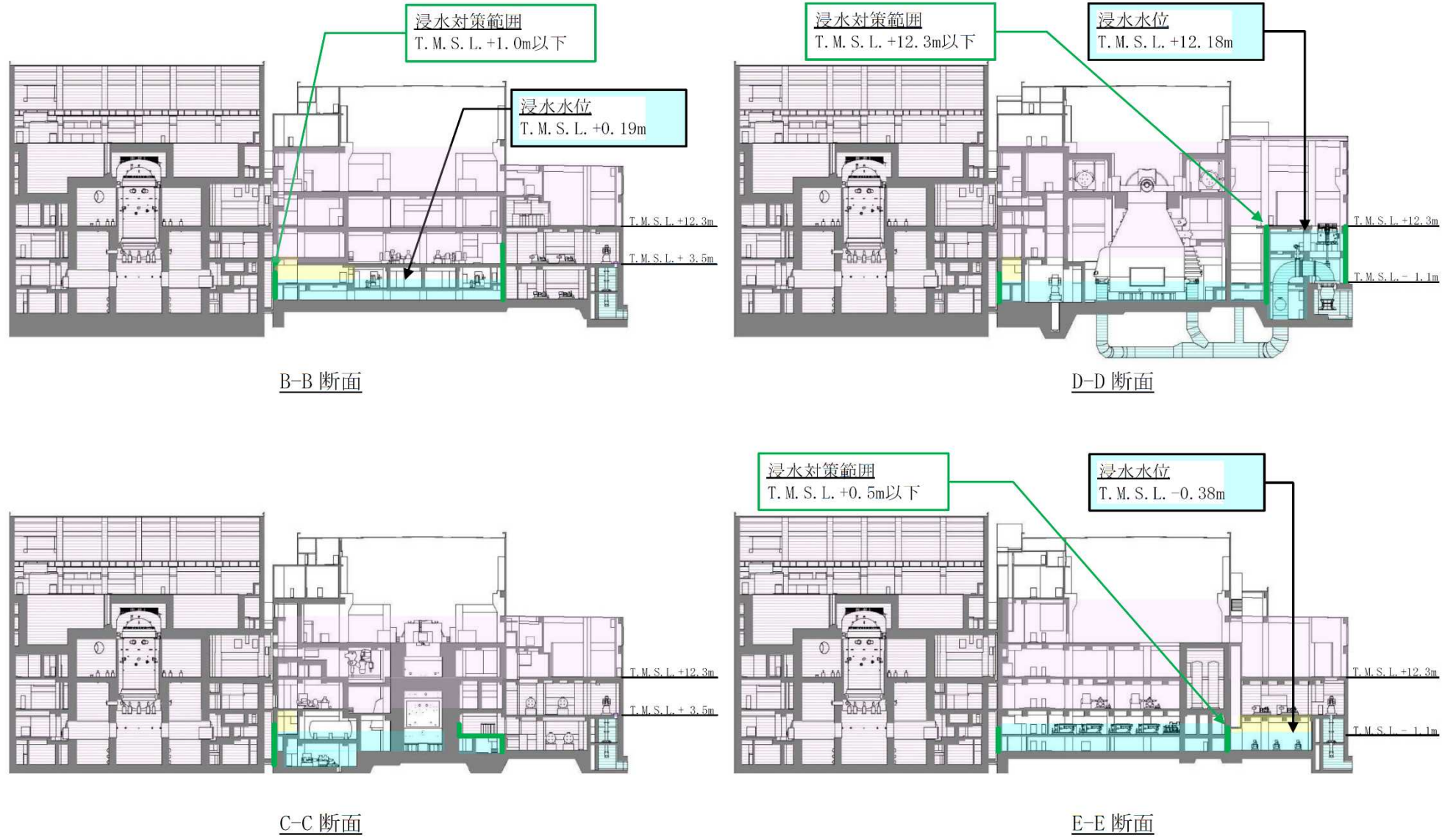
図 3-21 (3) タービン建屋内における溢水イメージと浸水防止設備設置概要 (縦断図) (2/2)
