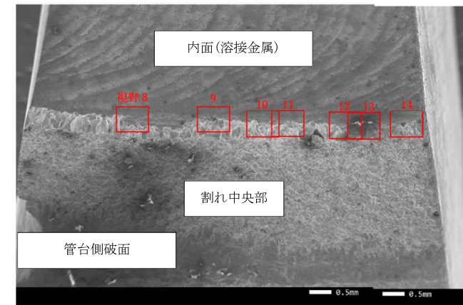
当該管 (T-2-2) の破面SEM (全体：管台側)
