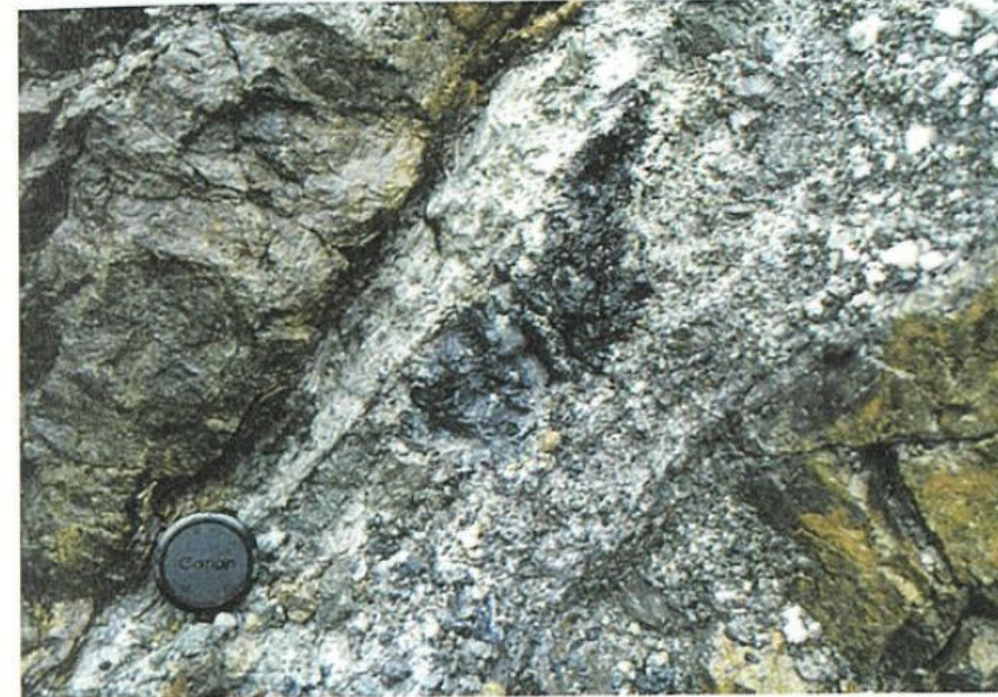
写真-1.13 中・古生代の砂岩中の断層に沿う熱水変質(断層沿いに熱水変質が選択的に進行して白色の粘土鉱物を生じ、掘削による応力開放と地下水の影響によって軟弱化している)
