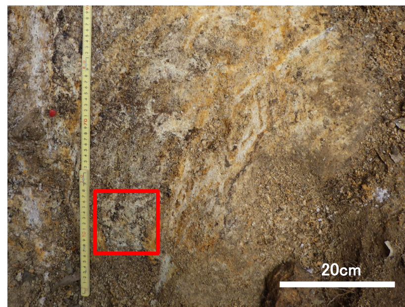
写真2. ②D-14破碎帯付近の試料採取位置(変質区分3)
