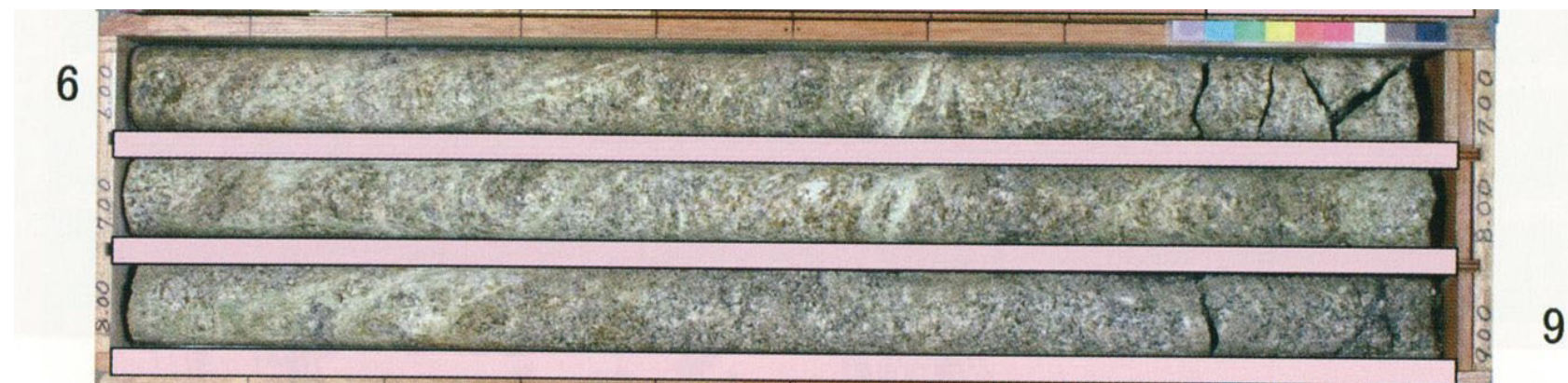
S22-1-2孔の深度6.1m~8.3m付近 花崗岩中に網目状の粘土を多く含む変質帯
