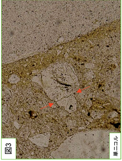
赤矢印は岩片の粒界を横断する破断面を示す
