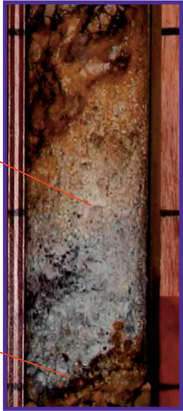
深度38.10mのフィルム状の細粒部 細粒部は局所的に分布する
