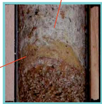
幅が膨縮する砂混じり粘土
