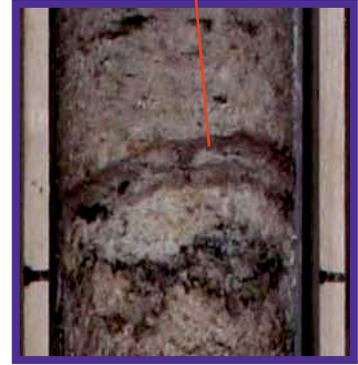
深度10.72～10.74mの連続性及び直線性が良い砂混じり粘土
