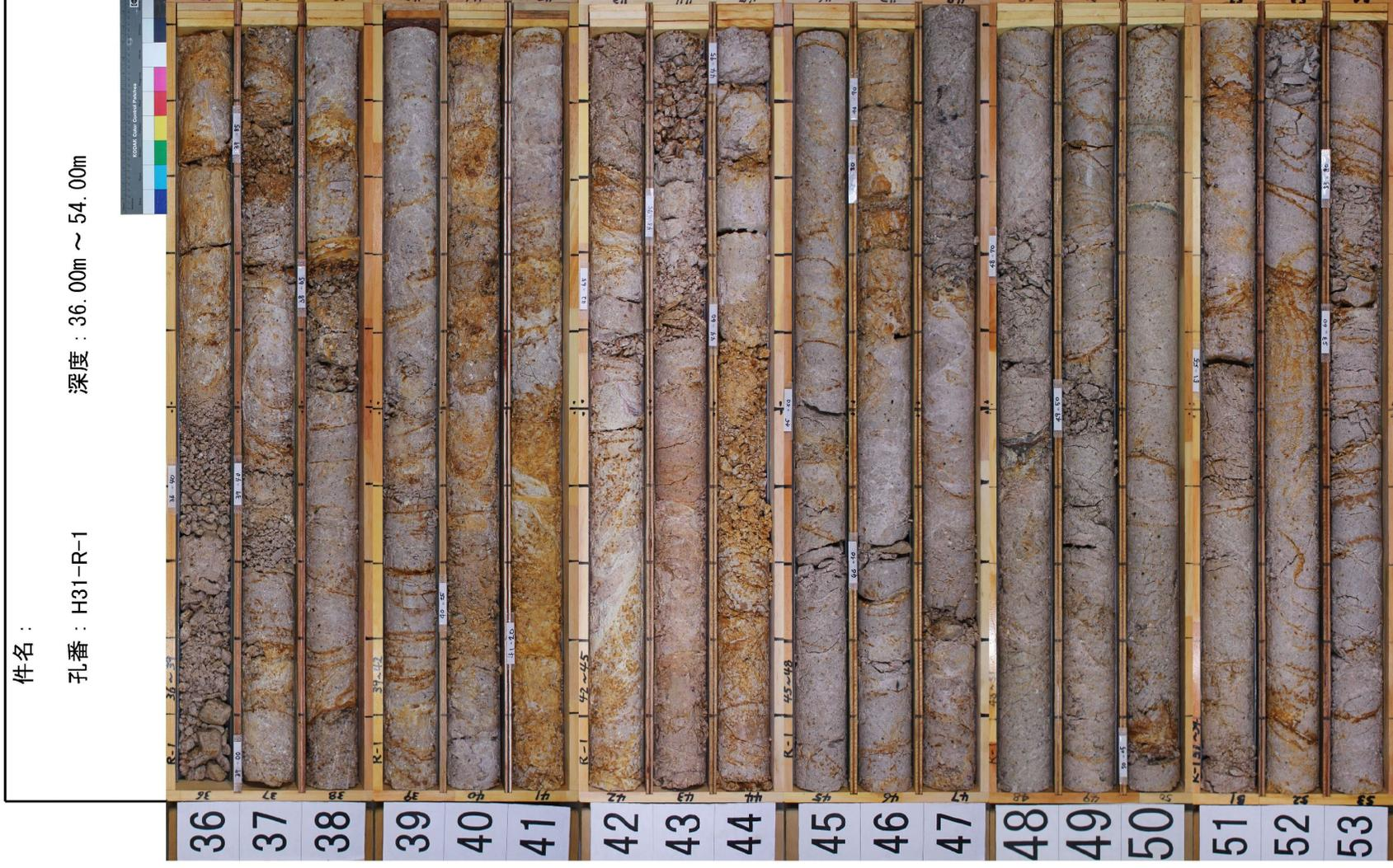
第7.4.4.238図 (18) ボーリング調査結果 (K断層の南方から2号炉原子炉建屋間) コア柱状図 (H31-R-1孔)
