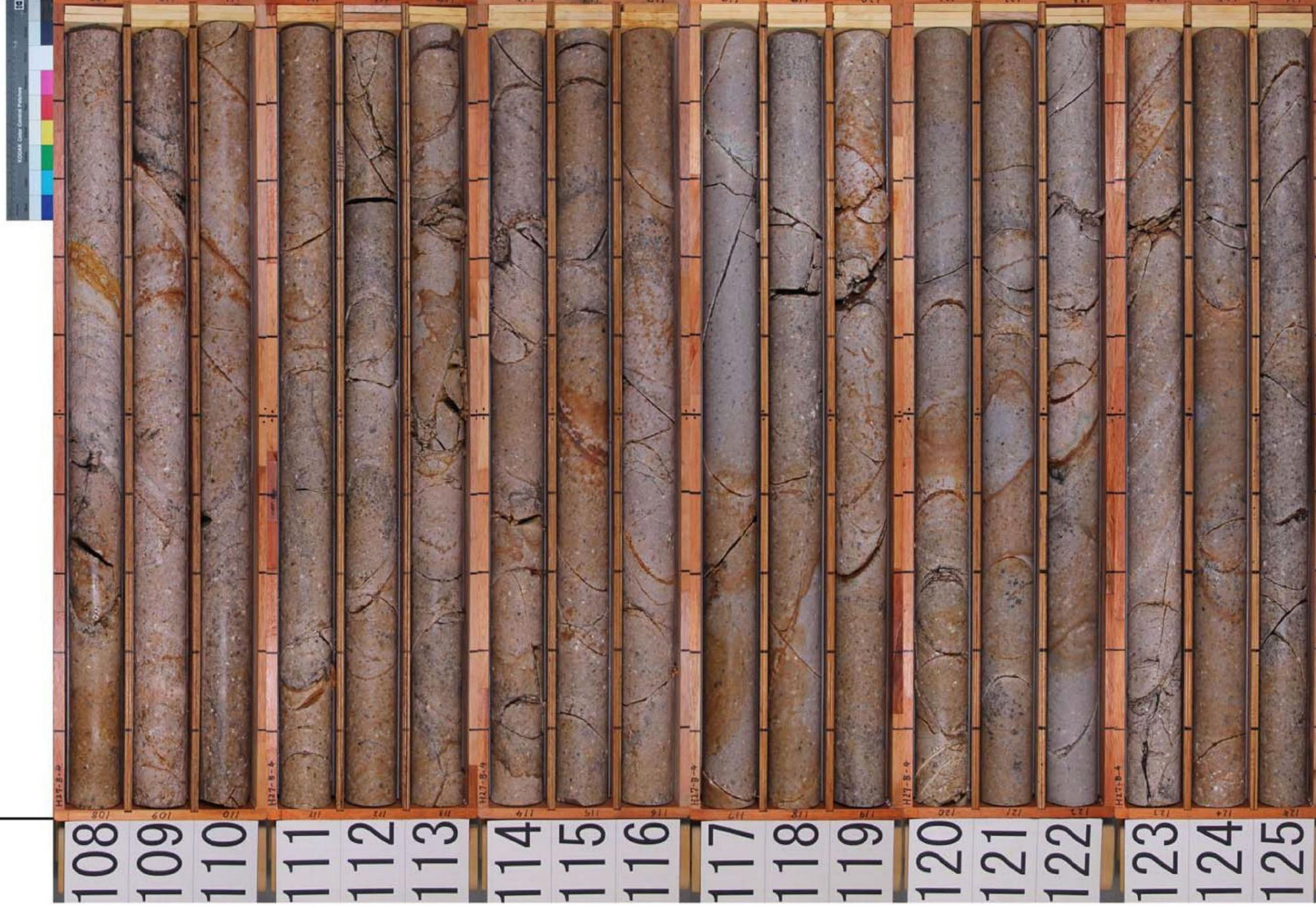
第7.4.4.227図 (35) ボーリング調査結果 (2号炉原子炉建屋付近) コア柱状図 (H27-B-4孔)
