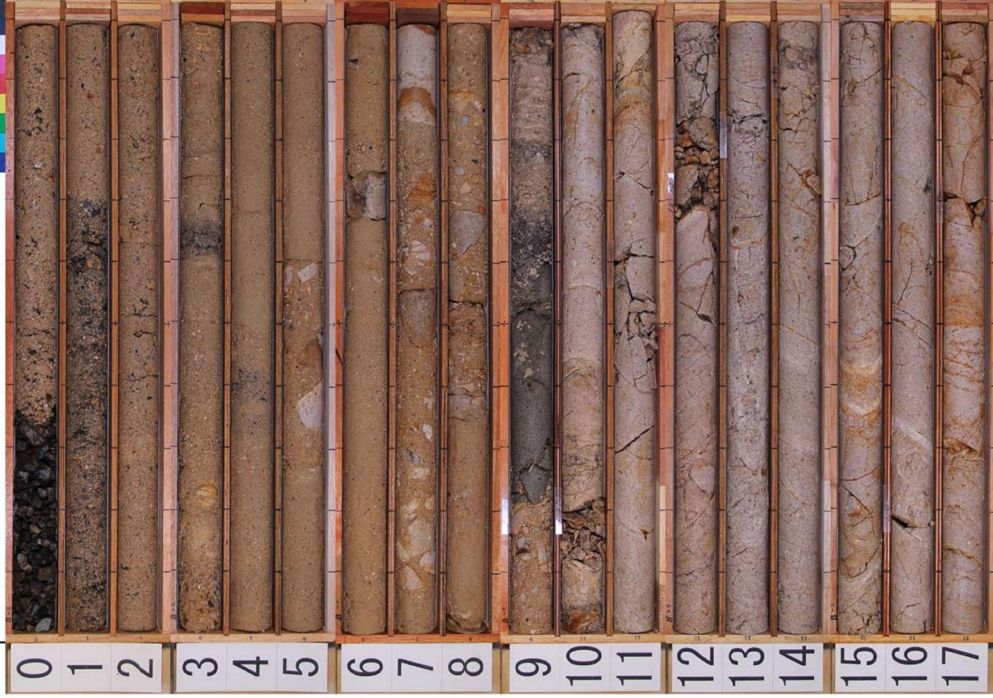
第7.4.4.226図 (37) ボーリング調査結果 (2号炉原子炉建屋付近) コア柱状図 (H27-B-3孔)
