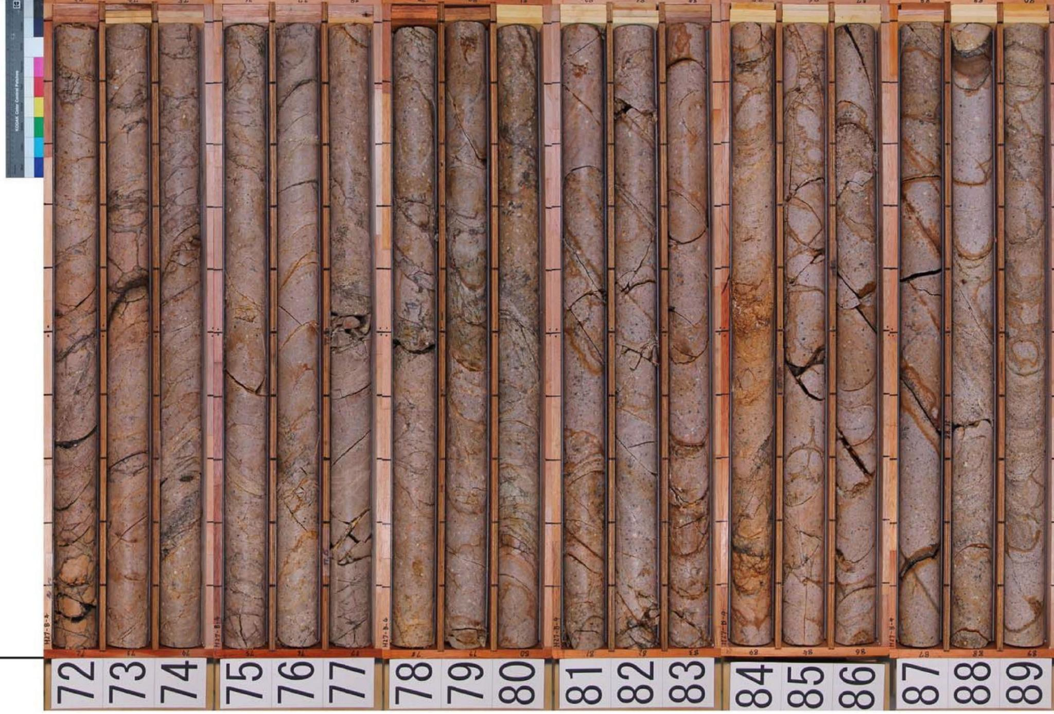
第7.4.4.227図 (33) ボーリング調査結果 (2号炉原子炉建屋付近) コア柱状図 (H27-B-4孔)
