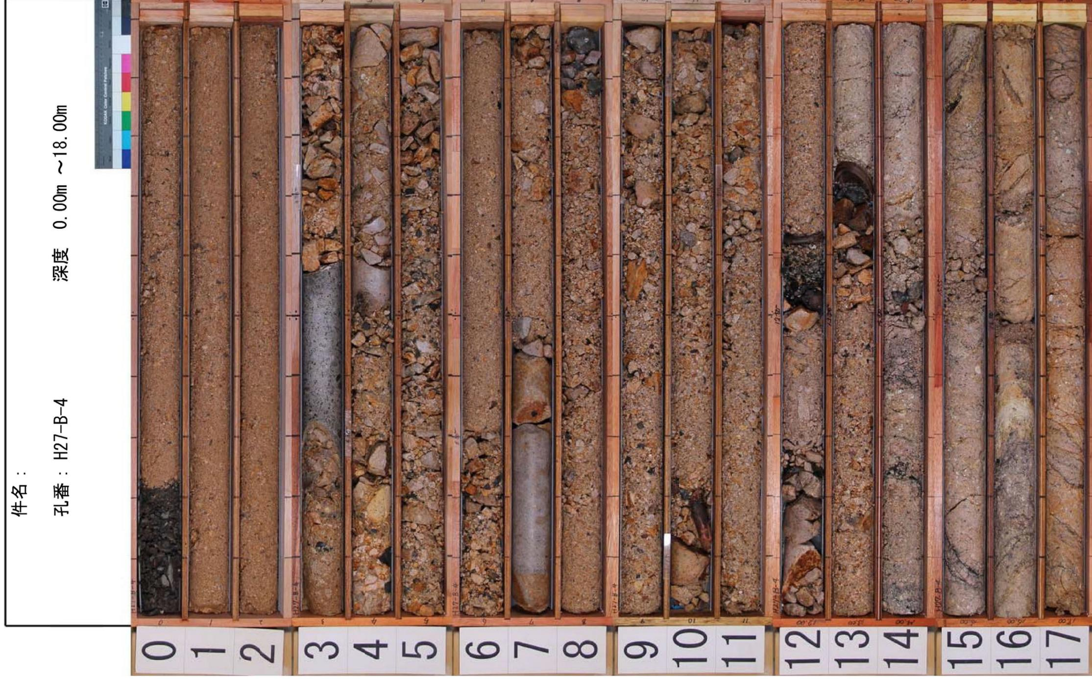
第7.4.4.227図 (29) ボーリング調査結果 (2号炉原子炉建屋付近) コア柱状図 (H27-B-4孔)
