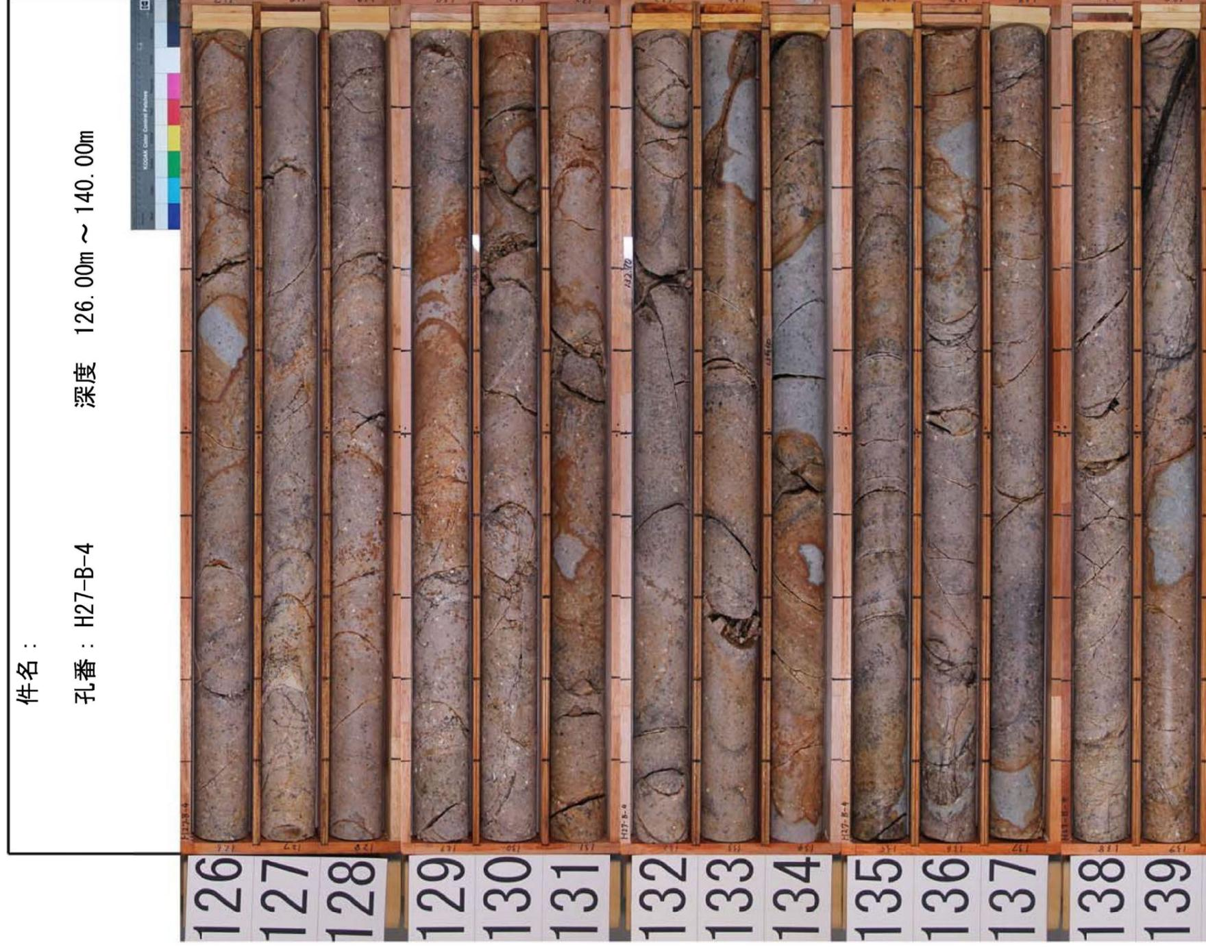
第7.4.4.227図 (36) ボーリング調査結果 (2号炉原子炉建屋付近) コア柱状図 (H27-B-4孔)
