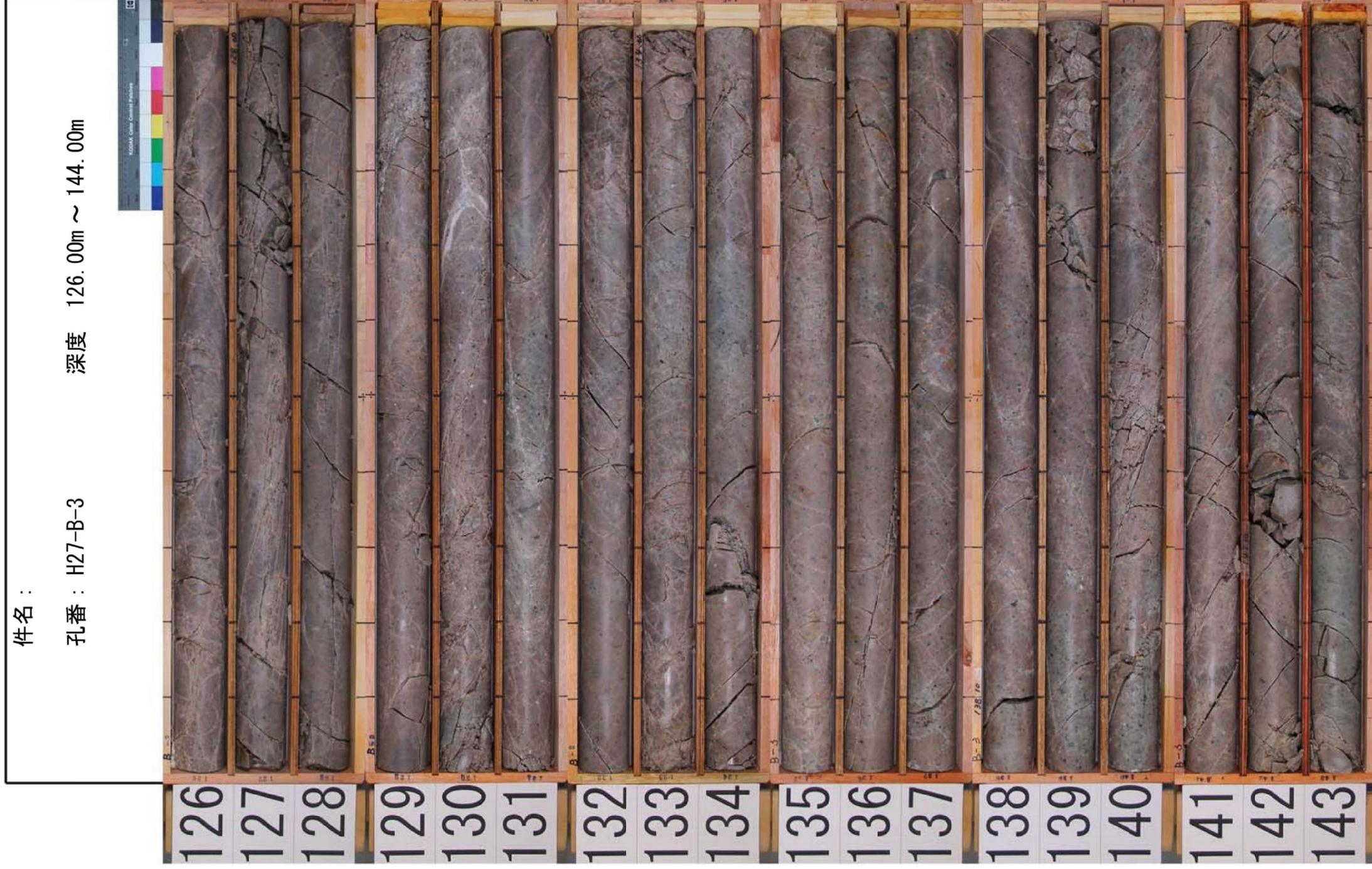
第7.4.4. 226図 (44) ボーリング調査結果 (2号炉原子炉建屋付近) コア柱状図 (H27-B-3孔)
