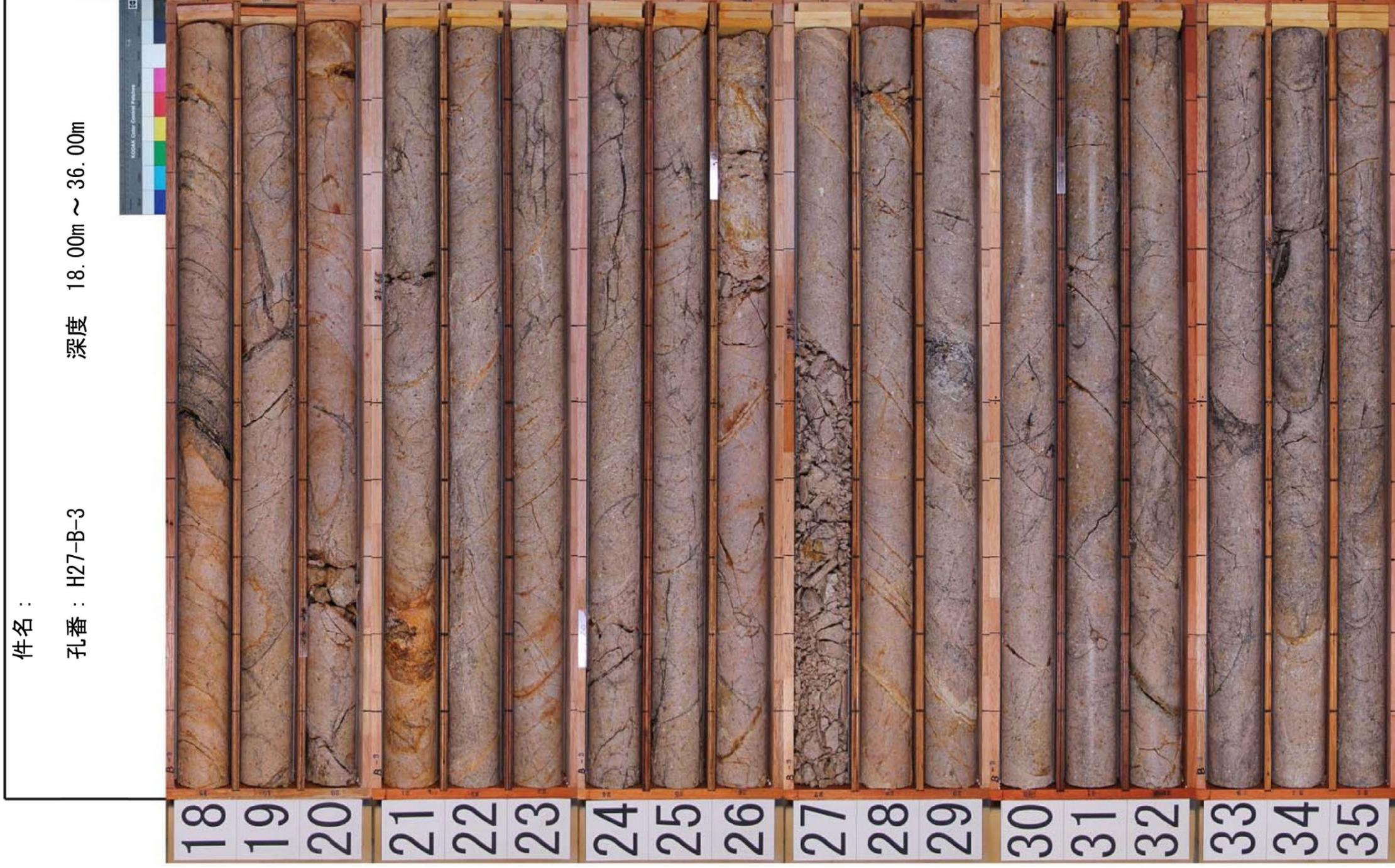
第7.4.4. 226図 (38) ボーリング調査結果 (2号炉原子炉建屋付近) コア柱状図 (H27-B-3孔)
