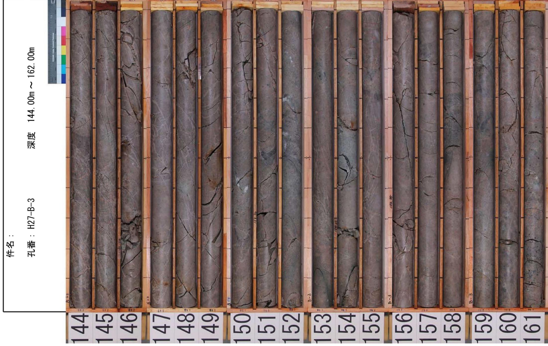
第7.4.4. 226図 (45) ボーリング調査結果 (2号炉原子炉建屋付近) コア柱状図 (H27-B-3孔)
