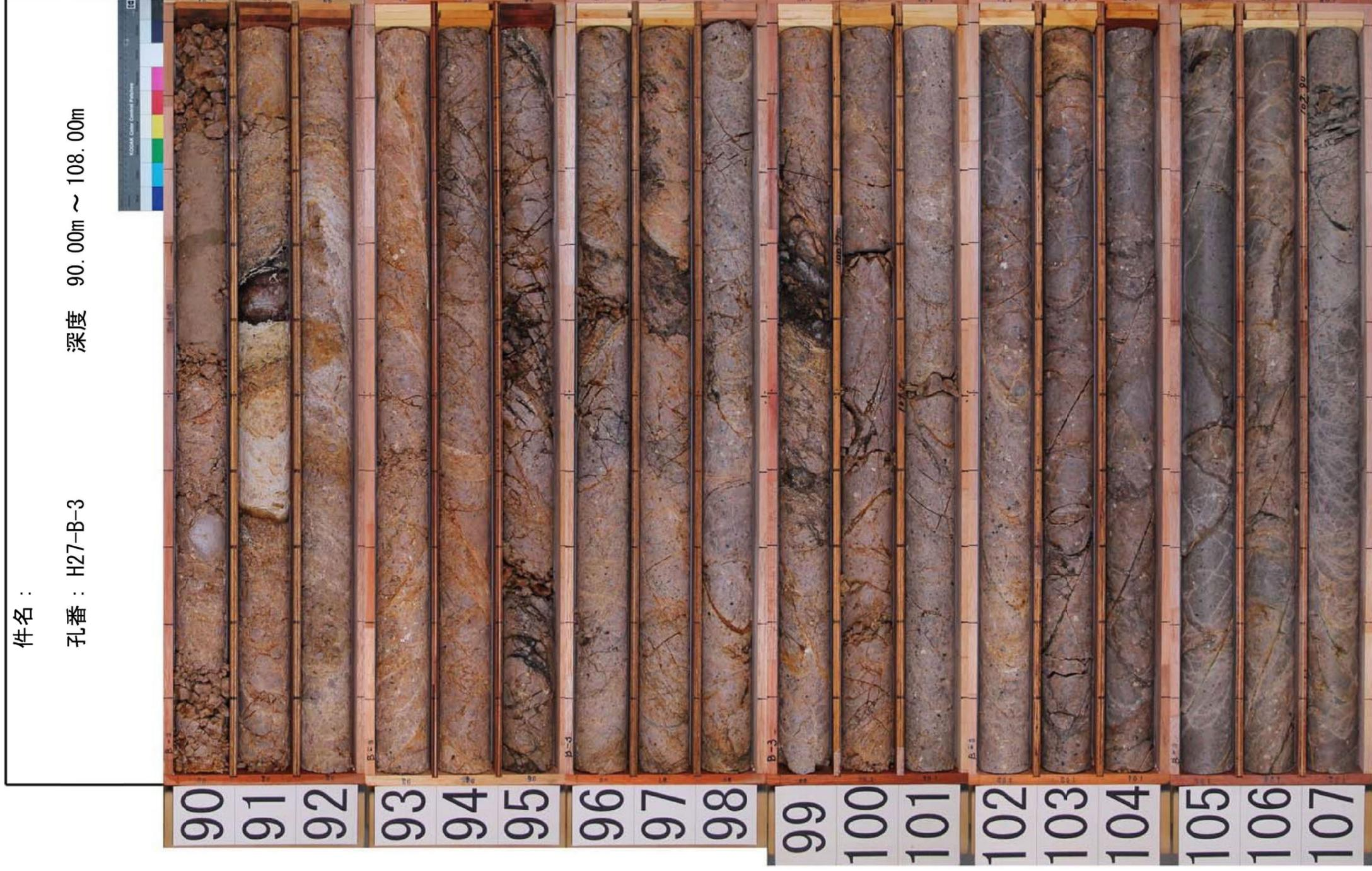
第7.4.4. 226図 (42) ボーリング調査結果 (2号炉原子炉建屋付近) コア柱状図 (H27-B-3孔)
