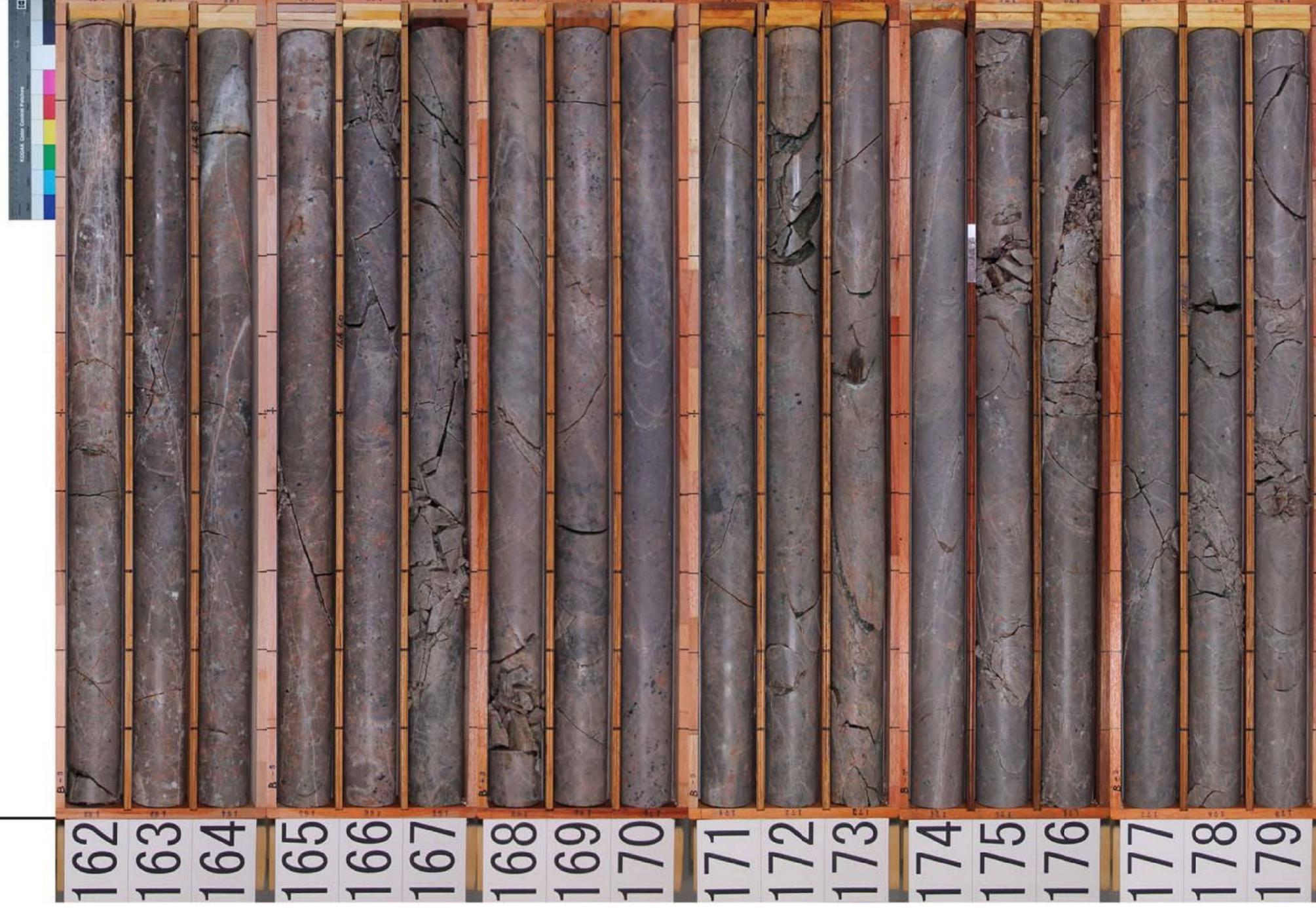
第7.4.4. 226図 (46) ボーリング調査結果 (2号炉原子炉建屋付近) コア柱状図 (H27-B-3孔)
