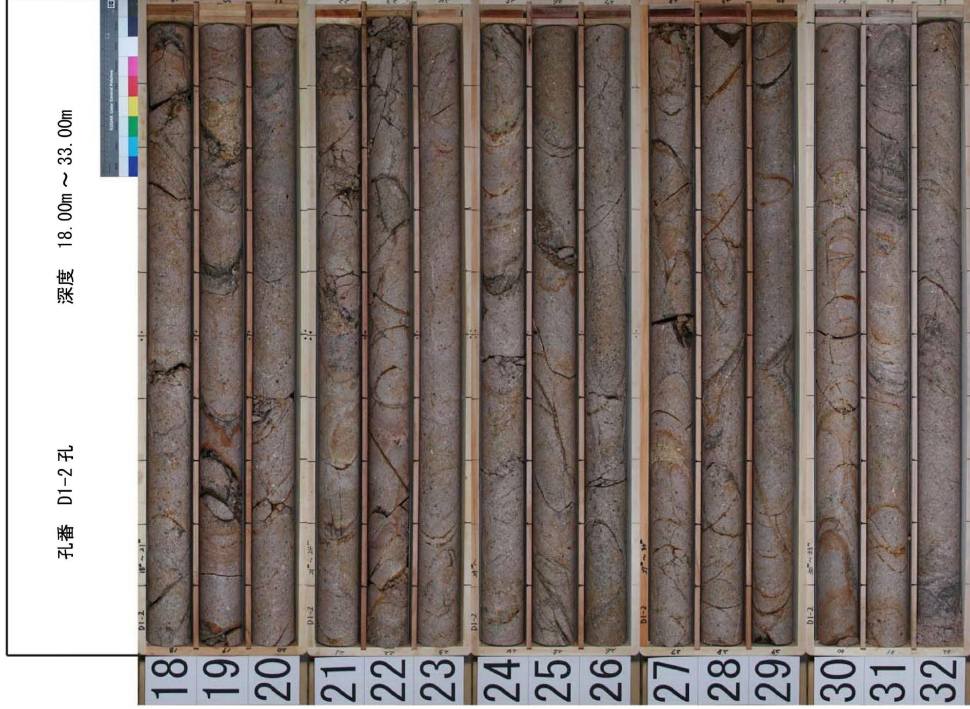
第7.4.4.222図 (9) ボーリング調査結果 (2号炉原子炉建屋付近) コア柱状図 (H24-D1-2孔)
