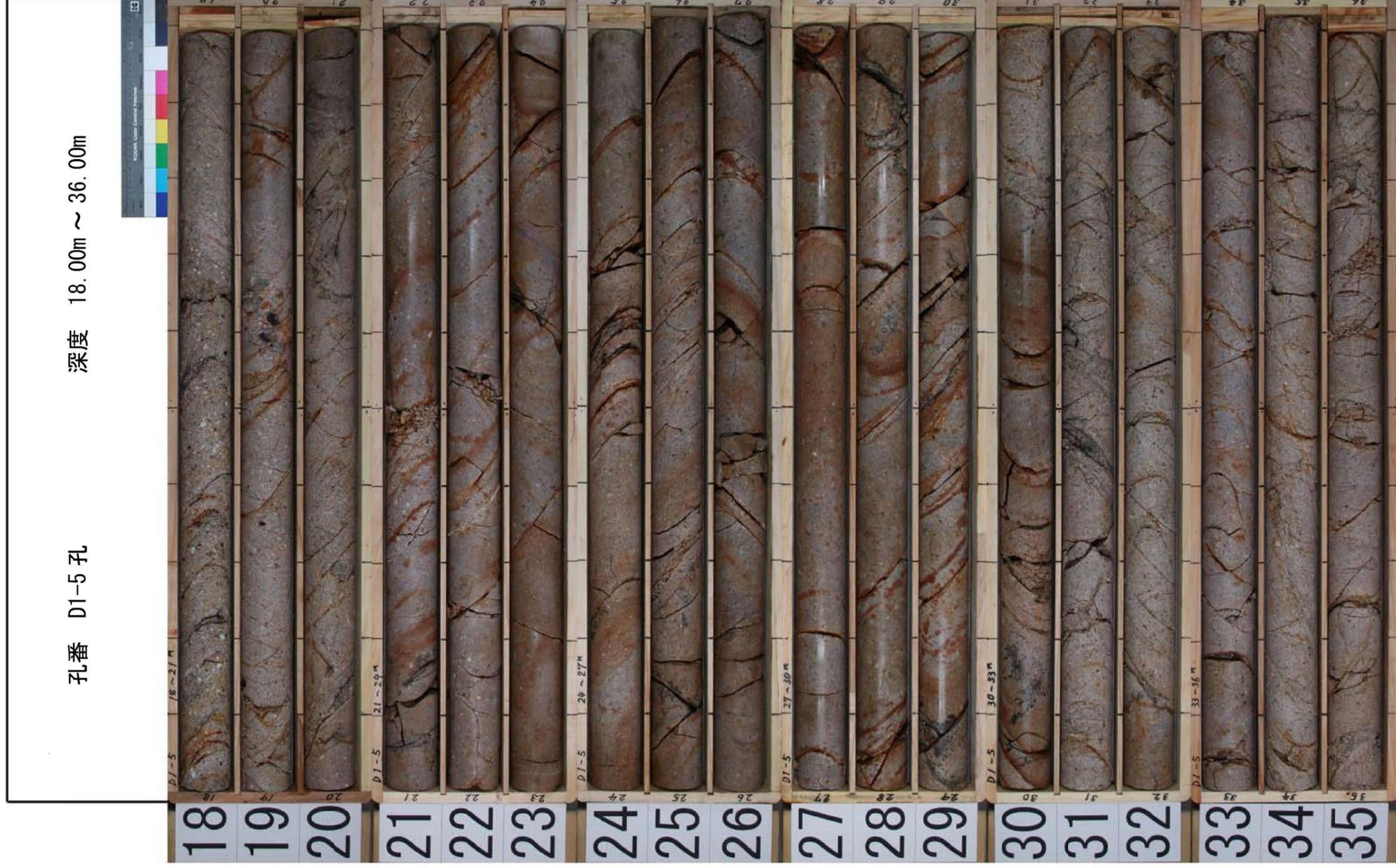
第7.4.4.225図 (13) ボーリング調査結果 (2号炉原子炉建屋付近) コア柱状図 (H24-D1-5孔)
