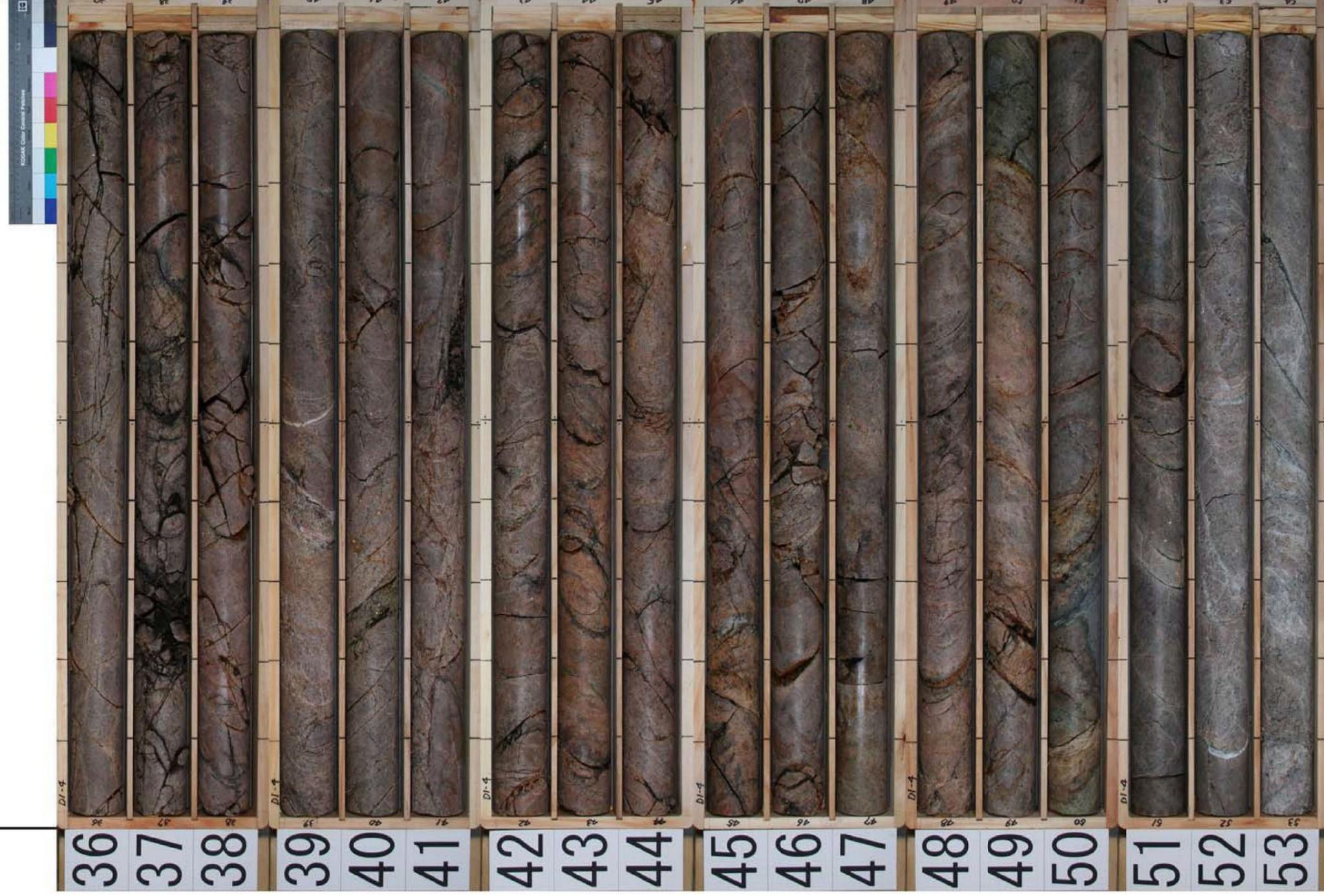
第7.4.4.224図 (18) ボーリング調査結果 (2号炉原子炉建屋付近) コア柱状図 (H24-D1-4孔)
