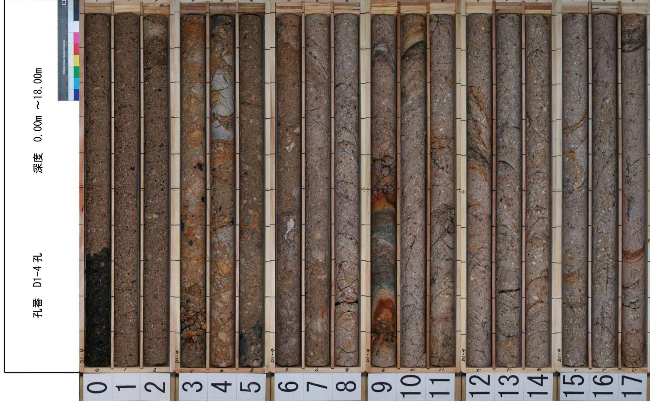
第7.4.4.224図 (16) ボーリング調査結果 (2号炉原子炉建屋付近) コア柱状図 (H24-D1-4孔)
