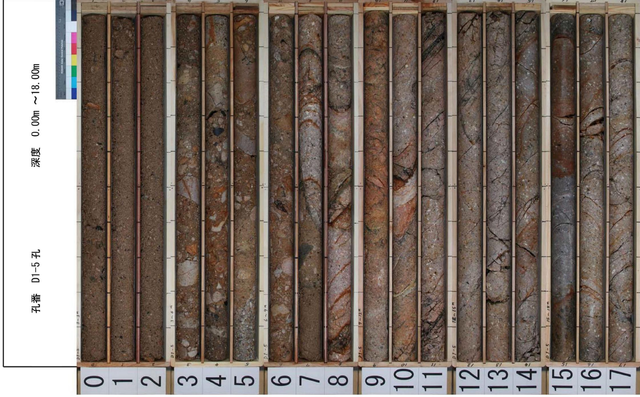
第7.4.4.225図 (12) ボーリング調査結果 (2号炉原子炉建屋付近) コア柱状図 (H24-D1-5孔)
