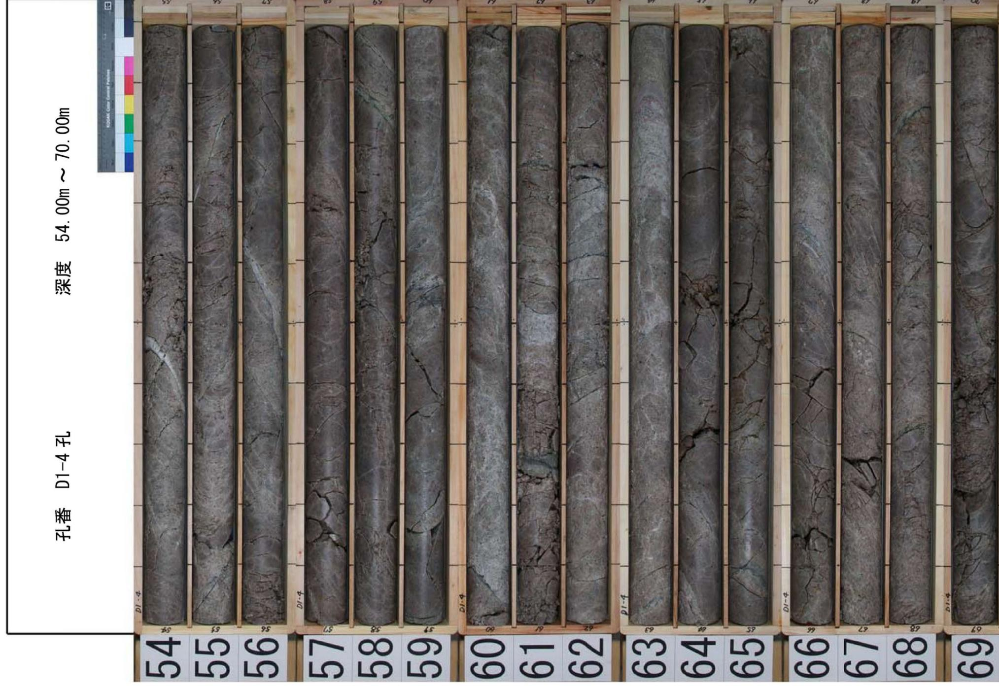
第7.4.4.224図 (19) ボーリング調査結果 (2号炉原子炉建屋付近) コア柱状図 (H24-D1-4孔)
