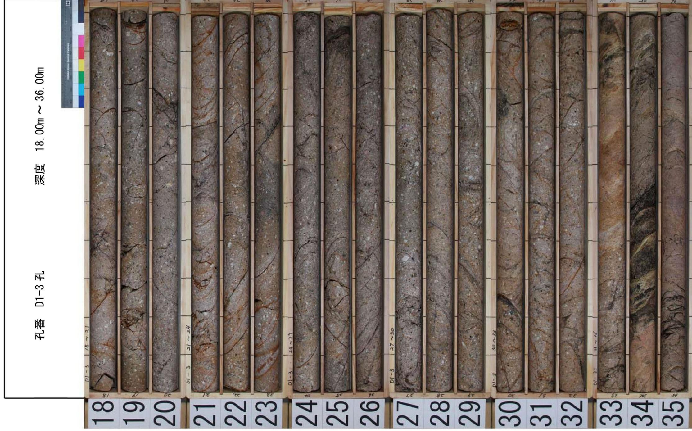
第7.4.4.223図 (14) ボーリング調査結果 (2号炉原子炉建屋付近) コア柱状図 (H24-D1-3孔)
