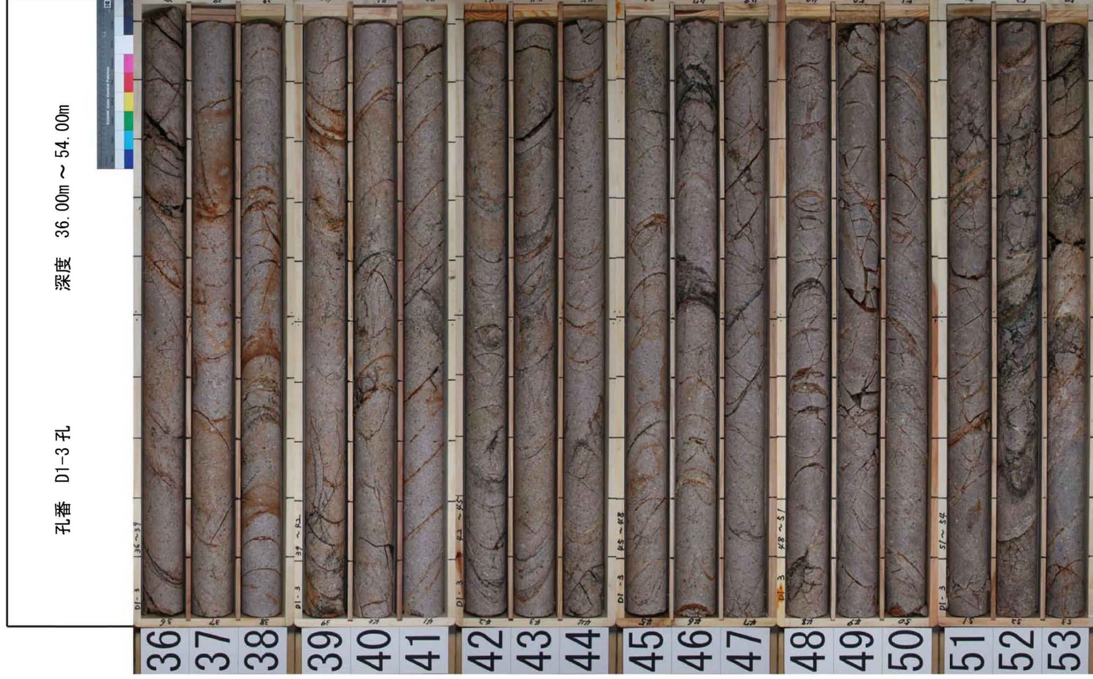
第7.4.4.223図 (15) ボーリング調査結果 (2号炉原子炉建屋付近) コア柱状図 (H24-D1-3孔)
