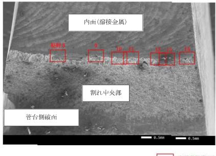
当該管 (T-2-2) の破面SEM (傾斜40°：管台側)
