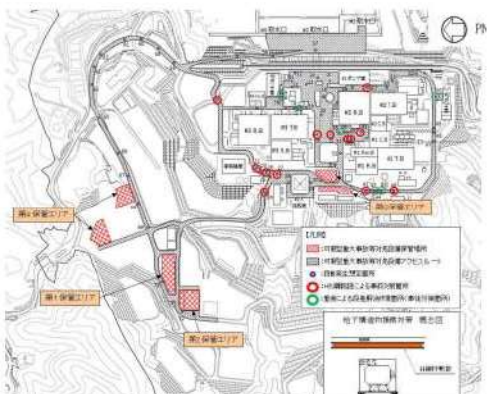
第4図 地下構造物の損壊による対策箇所（H形鋼敷設）
