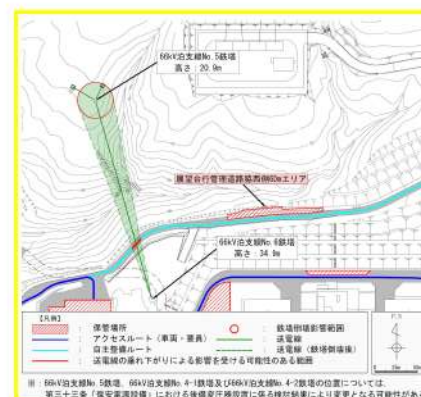
第3図 展望台行管理道路脇西側60mエリアと66kV泊支線送電鉄塔の関係
